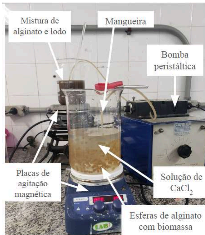
Figura 4.5 - Aparato experimental utilizado na preparação das esferas de alginato.
