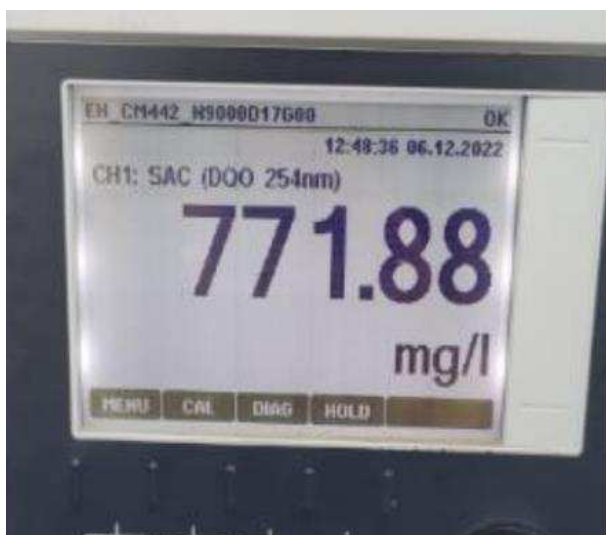
Figura 12 - Liquiline do sensor Viomax Cas51d demonstrando o resultado da análise
