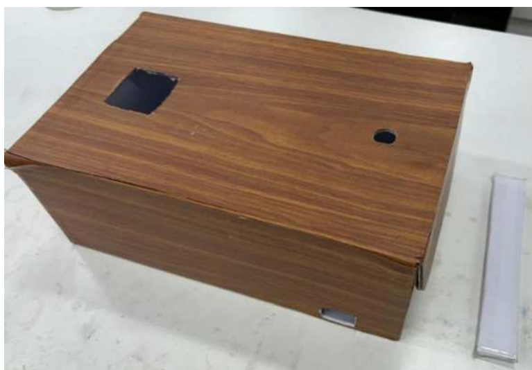
Figura 13 - Câmara de iluminação controlada e suporte da tiras usados durante a captura de imagem.
