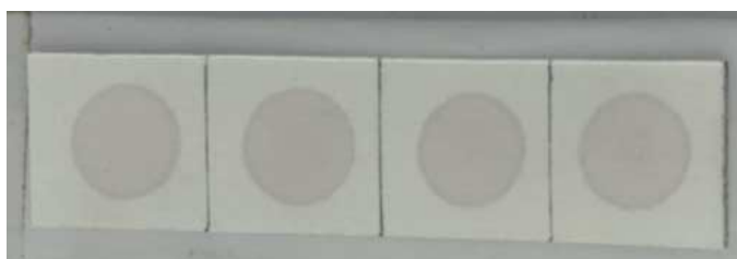
Figura 17 - Imagem de uma tira de papel, com o produto da reação entre o DPPH• e uma solução de ácido gálico de concentração 30,0 mg L -1 aplicado, que retrata o coffee ring effect .
