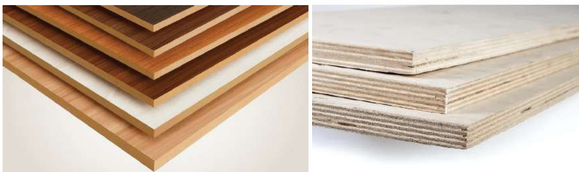
Figura 20 — MDF laminado x Compensado laminado
