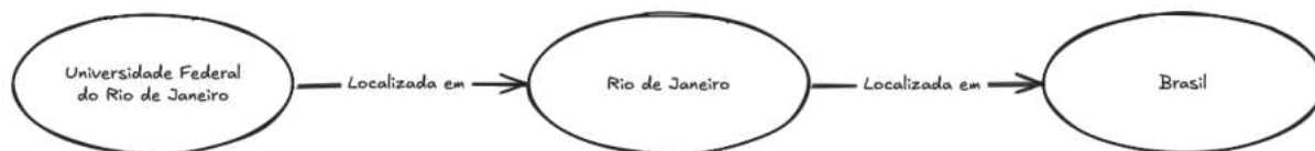
Figura 7 – Representação de duas triplas RDF evidenciando a relação entre três entidades
