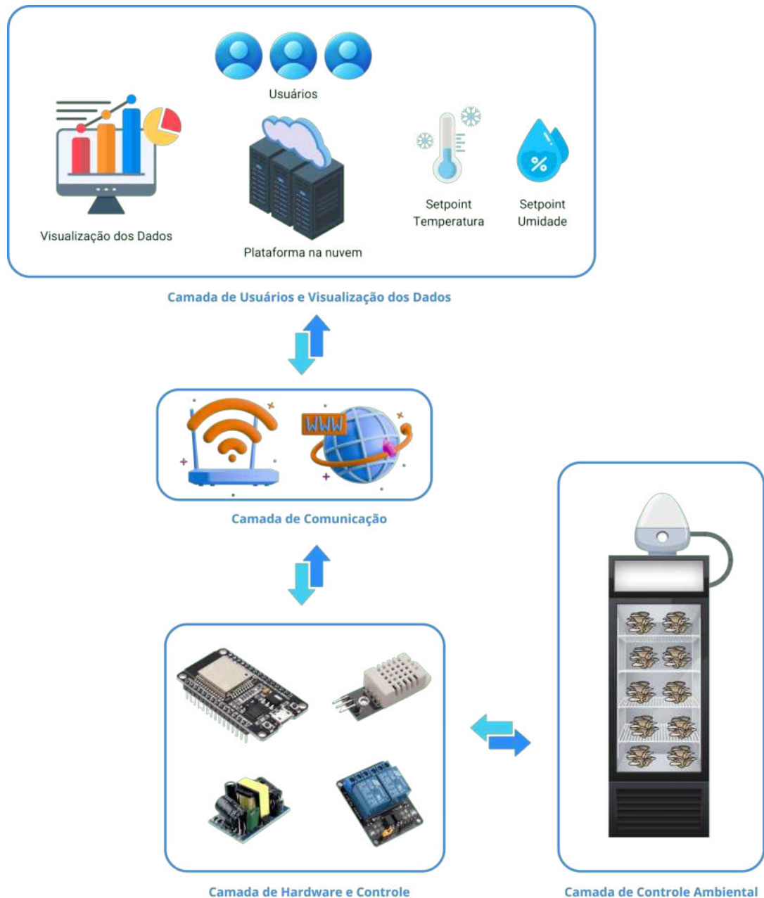
Figura A.2: Diagrama do sistema de controle ambiental baseado em IoT exibindo as camadas de interação do usuário e visualização de dados, camada de comunicação, componentes de hardware e ambiente controlado de cultivo de cogumelos.
