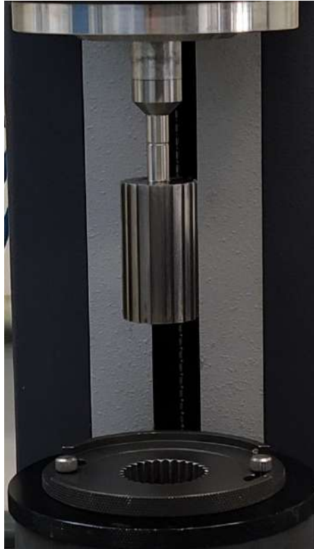
Figura 3.4: Geometria de cilindros concêntricos ranhurados utilizada nos ensaios reológicos
