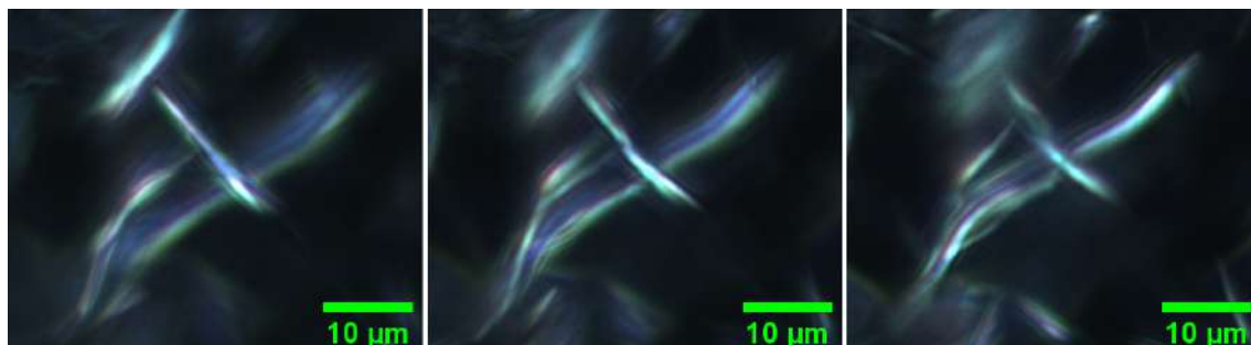
Figura 4.6: Comparação entre imagens com diferentes distâncias focais para um óleo modelo com concentração mássica de parafina de 2,5 % m/m resfriado a 0,5 °C·min -1 na temperatura de 4 °C.
