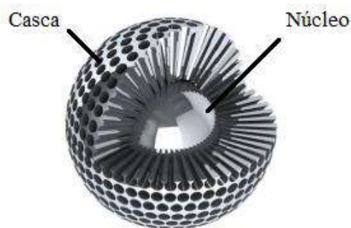
Figura 22 - Ilustração 3D de partícula núcleo-casca contendo canais mesoporosos na camada externa (adaptado de KOSARI; BORGNA; ZENG, 2020).
