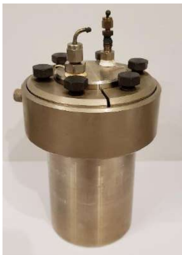
Figura 23 - Reator empregado no método solvotérmico.
