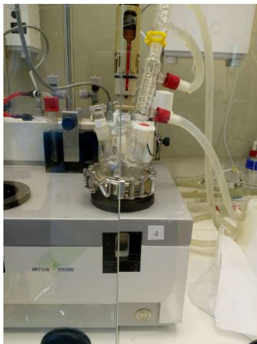
Figura 3.4: Reator empregado para a síntese dos nano-suportes.
