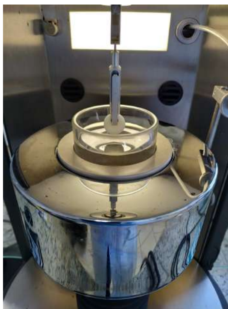
Figura 2.4: Tensiômetro utilizado para a medição do ângulo de contato.
