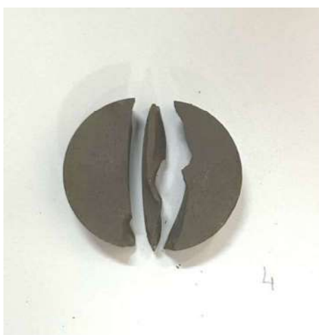
Figura 29 - Fratura da amostra no ensaio de compressão diametral
