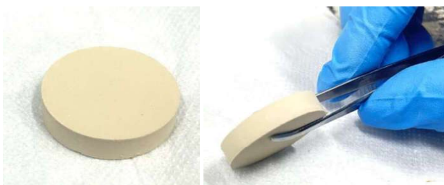
Figura 13 - Corpo de prova, em geometria de disco, após o processo de prensagem
