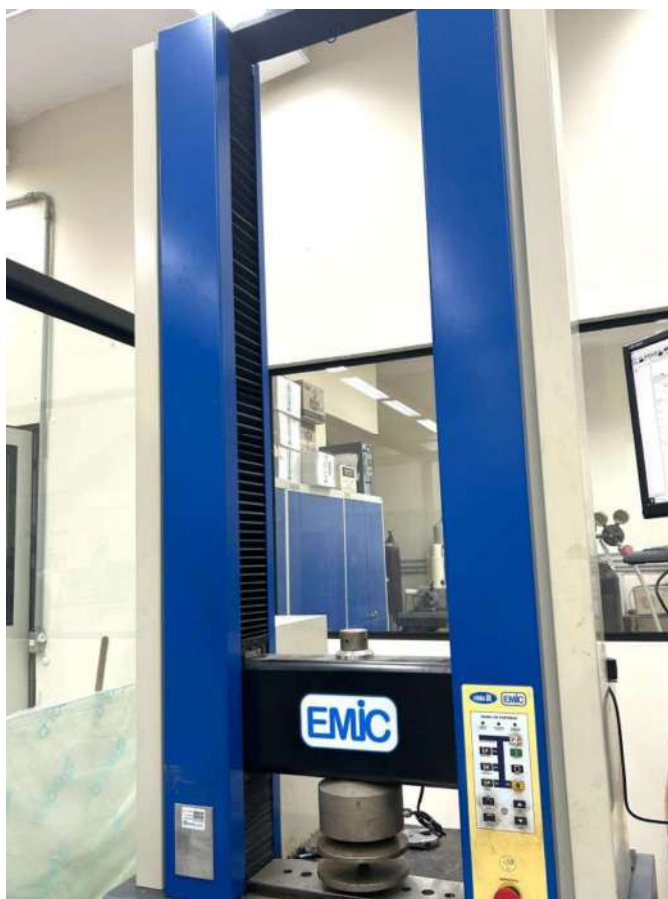
Figura 17 - Máquina de Ensaio Mecânico EMIC DL
