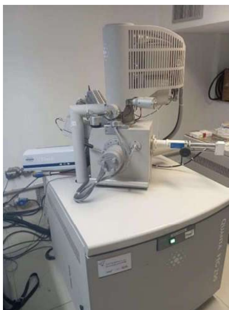
Figura 8 - Microscópio Eletrônica de Varredura acoplado ao Espectrômetro de Energia Dispersiva QUANTA 250 – FEG FEI
