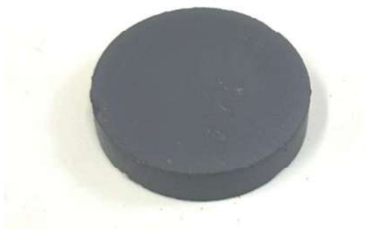
Figura 16 - Corpo de prova em geometria de disco após a sinterização
