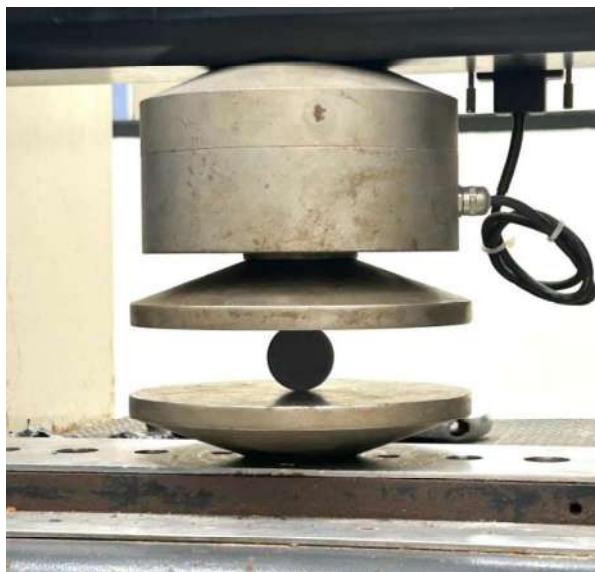
Figura 18 - Máquina de Ensaio Mecânicos EMIC DL com o corpo de prova em disco antes da fratura
