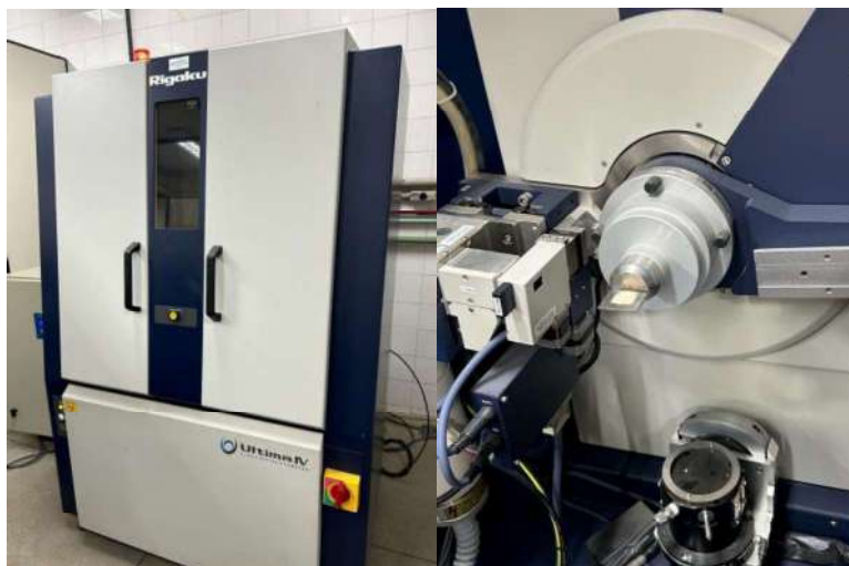
Figura 7 - Difratorômetro de Raio-X Rigaku Ultima IV
