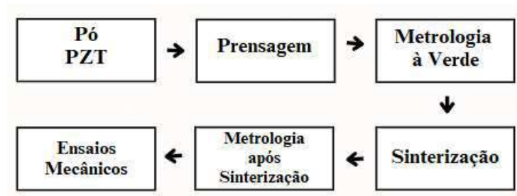
Figura 9 - Fluxograma do processo de produção dos corpos de prova
