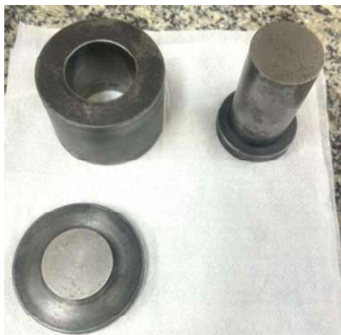
Figura 10 - Molde do processo de prensagem do disco
