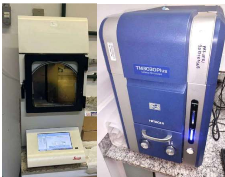
Figura 19 - Sistema de revestimento de alto vácuo e MEV
