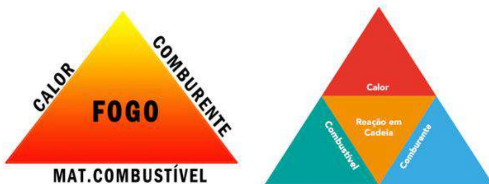
Figura 5 –Triângulo do fogo (à esquerda) e do Tetraedro do fogo (à direita)
