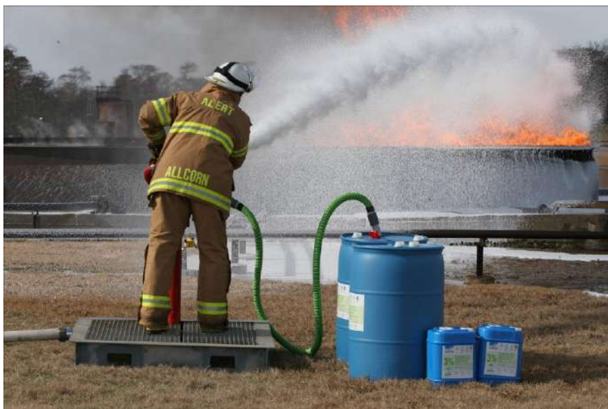
Figura 8 - Uso do LGE no combate a incêndio
