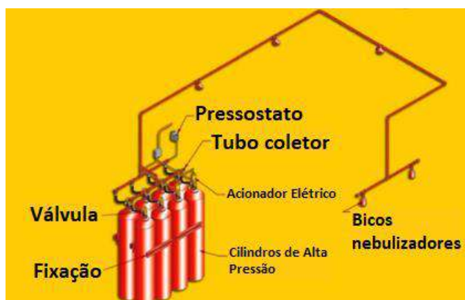
Figura 9 - Esquemático de sistema de combate a incêndio por CO 2
