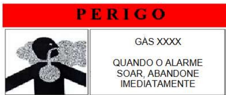
Figura 35 - Sinalização de advertência para interior dos ambientes protegidos
