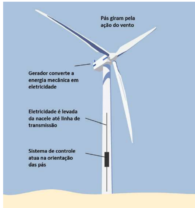
Figura 2.1: Aerogerador com eixo de rotação horizontal. Adaptado do National Energy Education Development Project [24].
