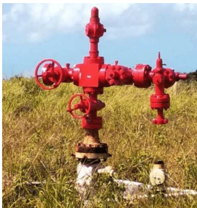
Figura 3: Exemplo de árvore de Natal seca, utilizada na produção e exploração de petróleo terrestre.
