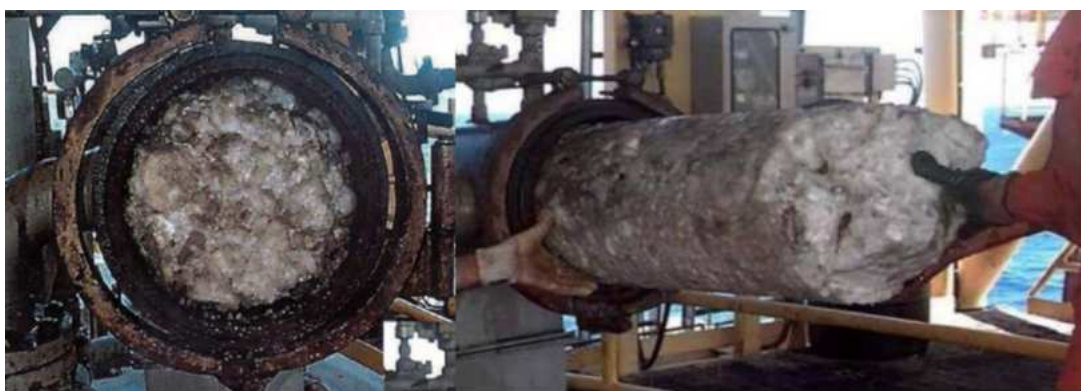
Figura 2: Imagem de hidratos visualizados em dutos de óleo e gás, formados durante o processo exploratório.
