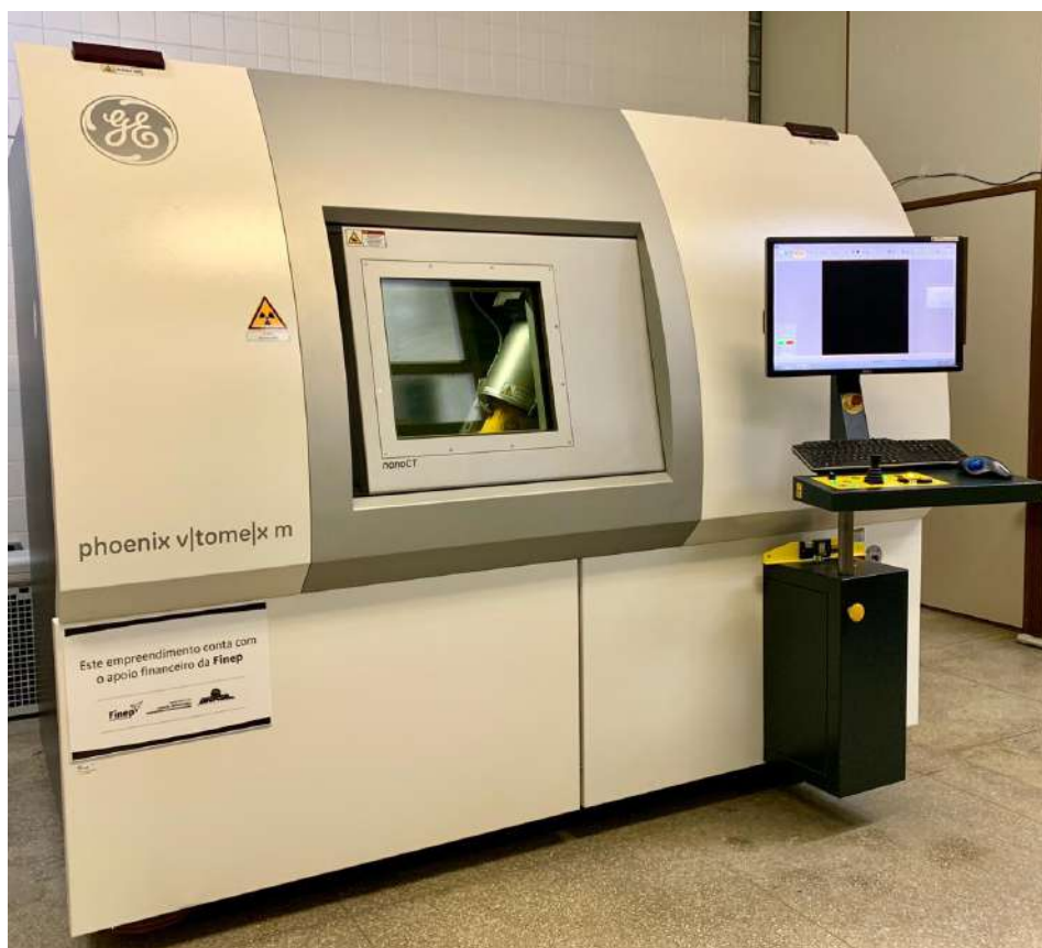
Figura 10 – A figura representa o sistema de microCT Phoenix V|tomex|m.
