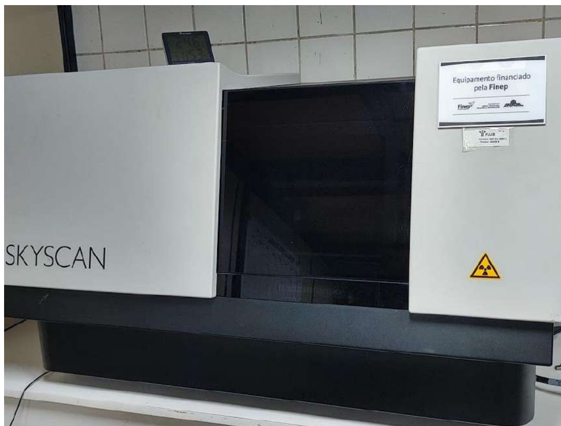
Figura 9 – A figura representa o sistema de microCT Skyscan Bruker modelo1173.
