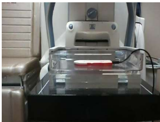
Figura 3.16 – Mamógrafo com o anodo/filtro Mo/Mo, e os seguintes componentes: três fantasmas, que juntos somam 45 mm de espessura, além de 8 mm de espaçadores; acima da bandeja da compressão, está o multímetro NOMEX.
