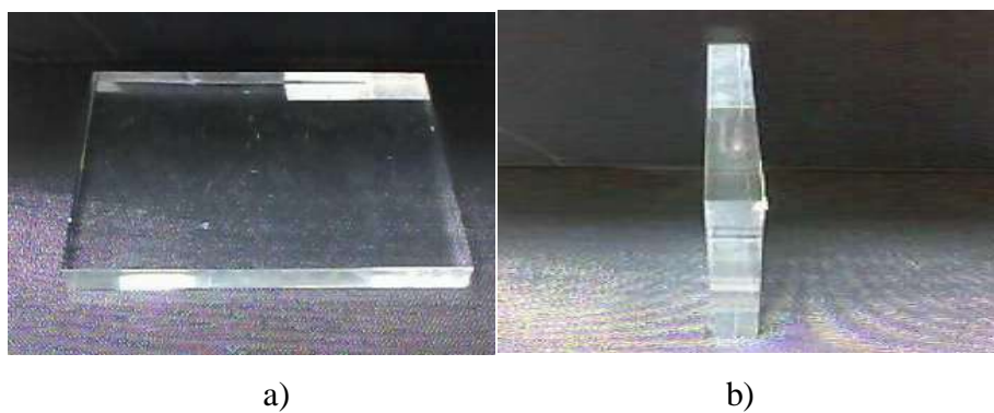
Figura 3.3 – Fantoma de dimensões 18 cm x 24 cm x 2,0 cm, nas visões (a) frontal e (b) lateral.
