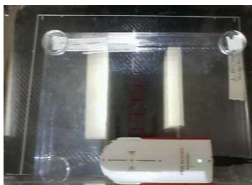
Figura 3.18 – Visão frontal da disposição dos equipamentos no mamógrafo Selenia Dimensions . De cima para baixo, são mostrados: o multímetro NOMEX, a bandeja de compressão, os espaçadores e os fantasmas.
