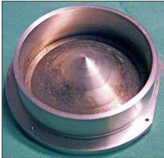
Figura 3.6: Flattening Filter utilizado para produzir um feixe de 6 MV(LIND,2008)
