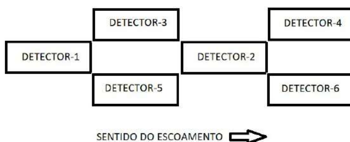
Figura 52. Diagrama de posicionamento dos detectores no dispositivo experimental
