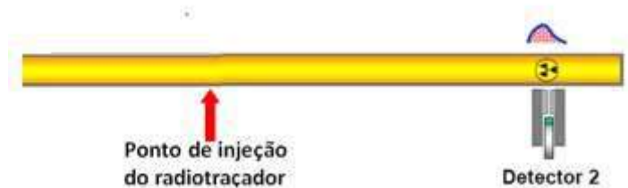
Figura 25. Diagrama esquemático para obtenção de medidas pela Técnica de Contagem Total (GONÇALVES, 2013)
