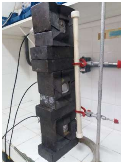
Figura 38. Aparato experimental foi desenvolvido para a verificação da possibilidade de precipitação, volatilização e reação do radiotraçador com as paredes do duto
