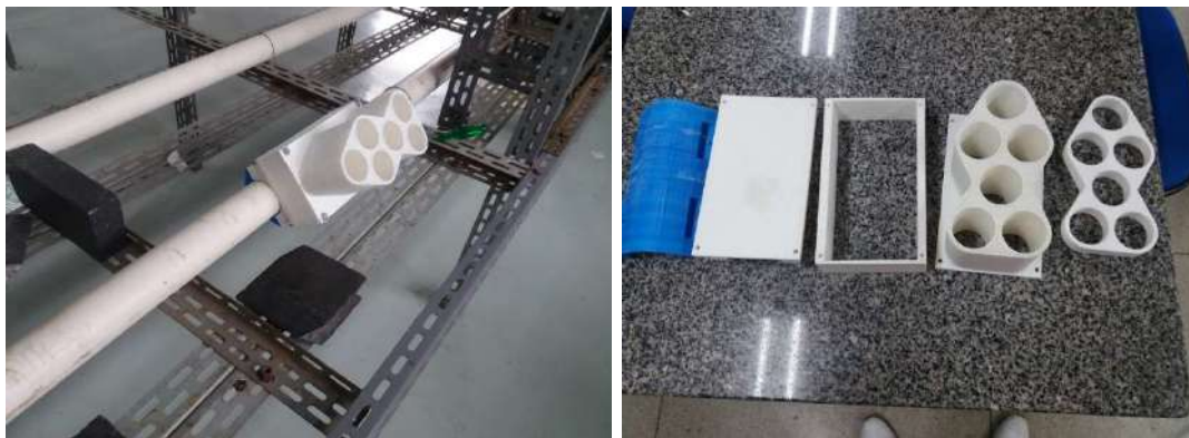
Figura 40. Dispositivo para verificação de escoamento estratificado
