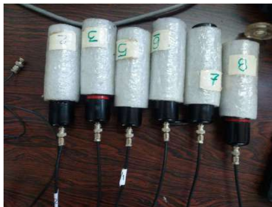
Figura 37. Detectores conectados cintiladores NaI 1"x1" por cabos coaxiais
