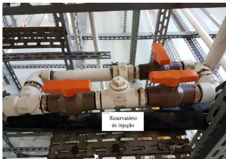
Figura 32. Sistema de injeção do radiotraçador na linha de transporte
