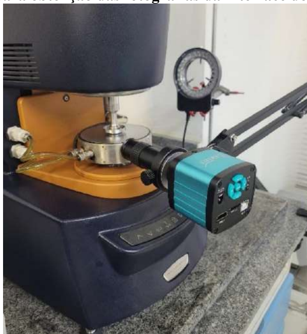
Figura 1: Setup para obtenção das fotografias da interface do óleo no reômetro.
