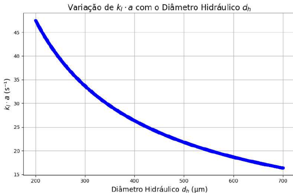
Figura 18 - Variação do k_{ia} Conforme Variação do Diâmetro Hidráulico para Demais Constantes Fixas (Velocidade do Líquido = 2 M/S)
