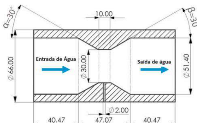
Figura 11- Tubo Venturi
