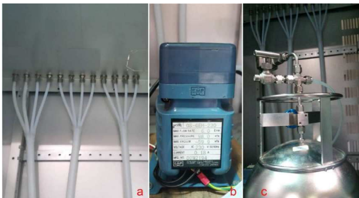
Figura 31 - a) Tubos de Teflon®; b) Bomba elétrica; c) Válvula de três vias. Fonte: O autor.
