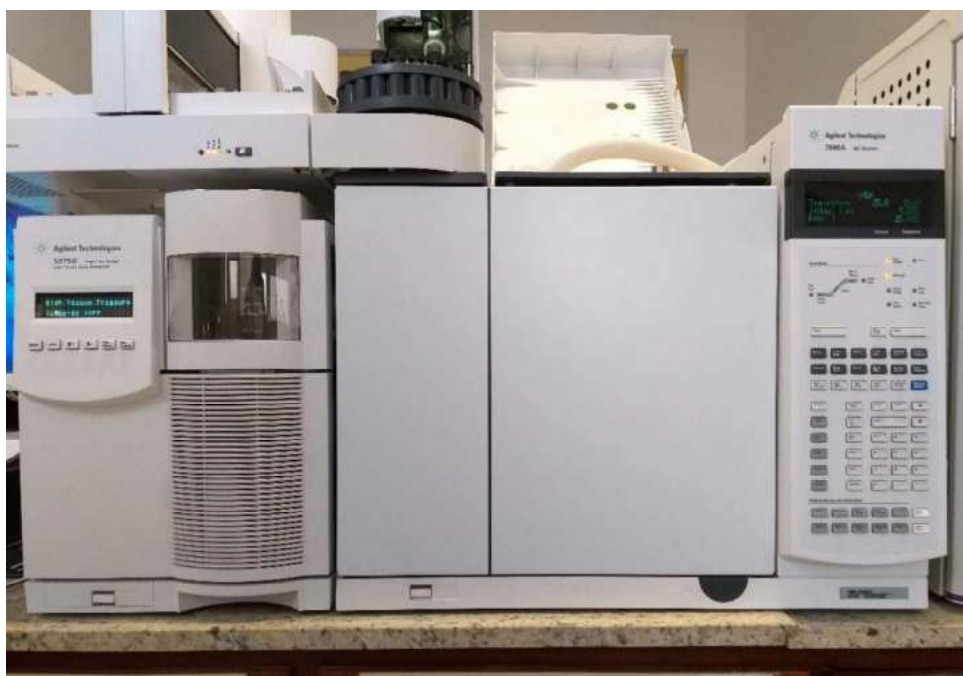
Figura 32 - Equipamento de GC-MS (cromatógrafo a gás Agilent Technologies GC 7890A acoplado a um espectrômetro de massas Agilent Technologies MS 5875C ). Fonte: O autor.
