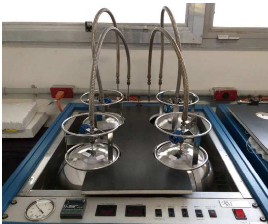
Figura 30 - Equipamento da RM Environmental Systems Inc. , modelo 960, para limpeza e evacuação dos canisters . Fonte. O autor.
