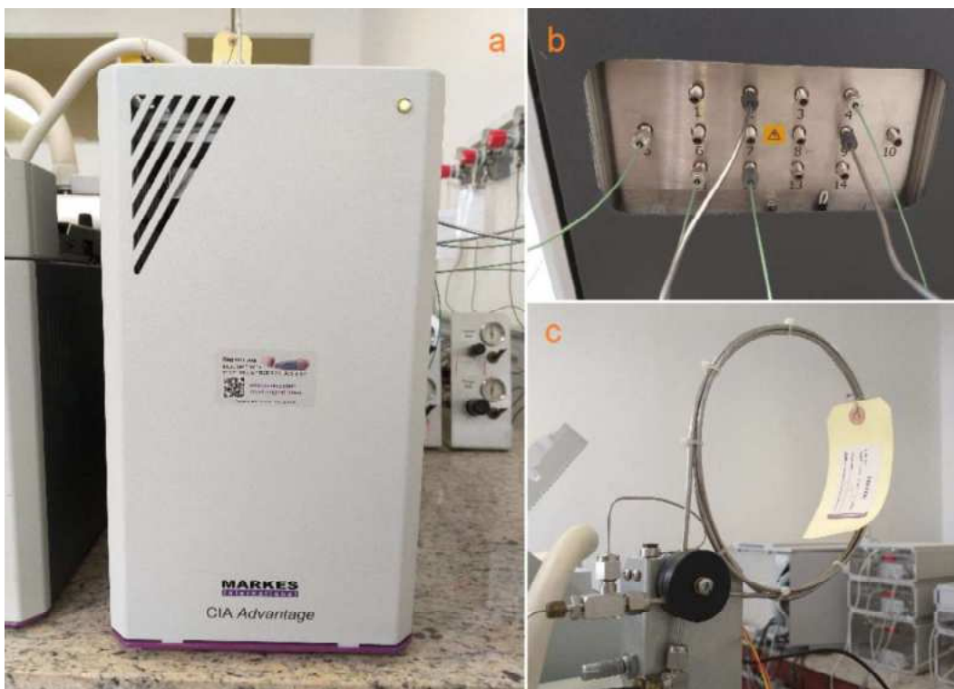
Figura 33 - a) Markes CIA Advantage (vista frontal); b) Markes CIA Advantage (vista lateral); c) Nafion® dryer . Fonte: O autor.
