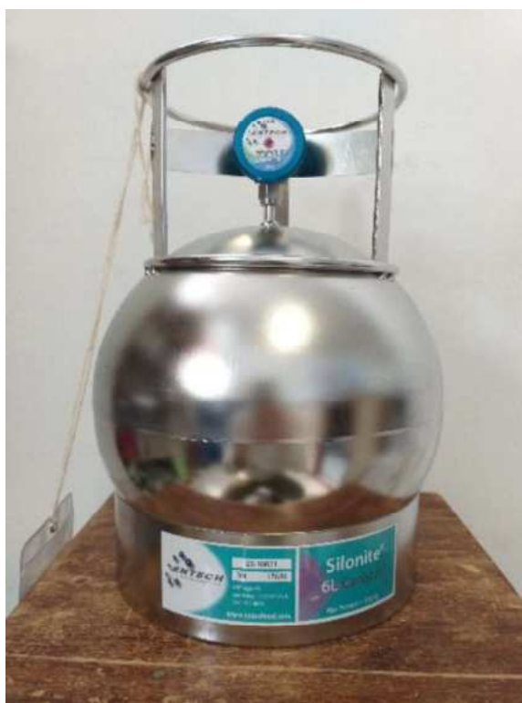
Figura 29 - Canister de aço inox eletropolido com revestimento interno de Silonite®, utilizado para a coleta das amostras a serem analisadas. Fonte: O autor.
