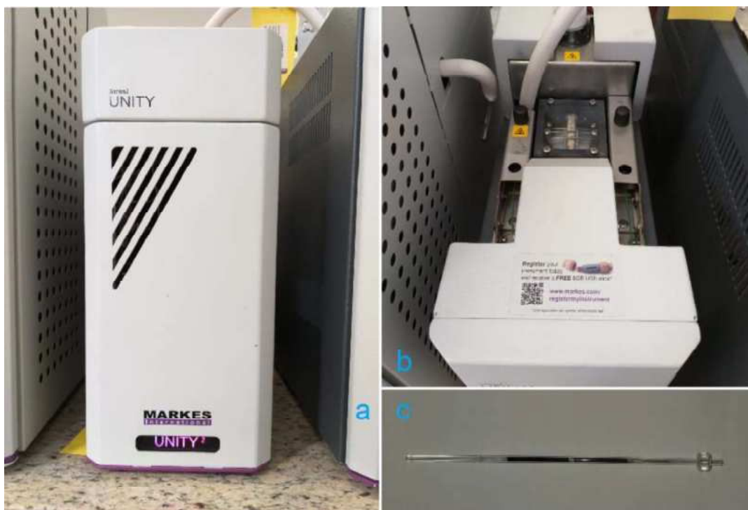
Figura 34 - a) Markes Unity 2 (vista frontal); b) Markes Unity 2 (vista superior); c) Armadilha fria. Fonte: O autor.
