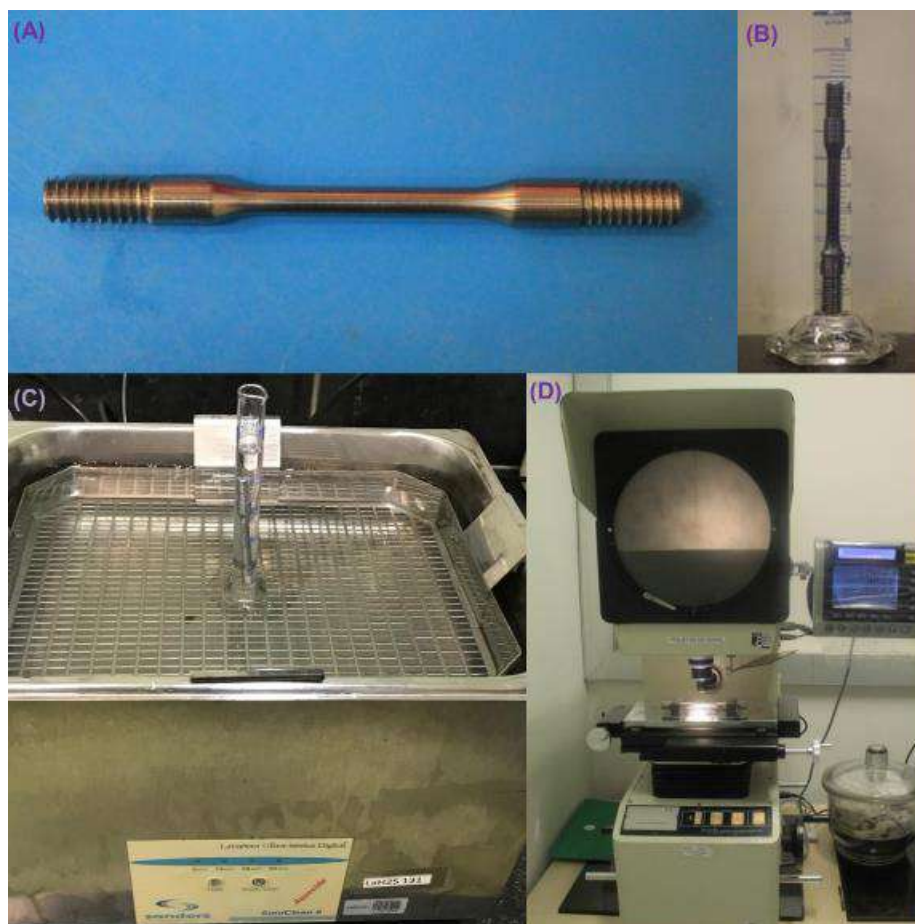
Figura 52. Etapas de preparo dos corpos de prova antes da realização dos ensaios de BTBD: (a) corpo de prova após lixamento e limpeza, (b e c) corpo de prova imerso em acetona PA e desengordurado em banho de ultrassom, (d) realização das medidas do corpo de prova em projetor de perfil.
