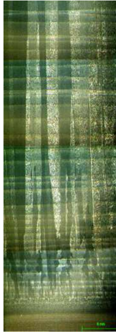
Figura 9. Parede de 6Ti-4Al-V formada pelo processo de WAAM exibindo grãos colunares grosseiros entre camadas (WANG et.al. , 2011).
