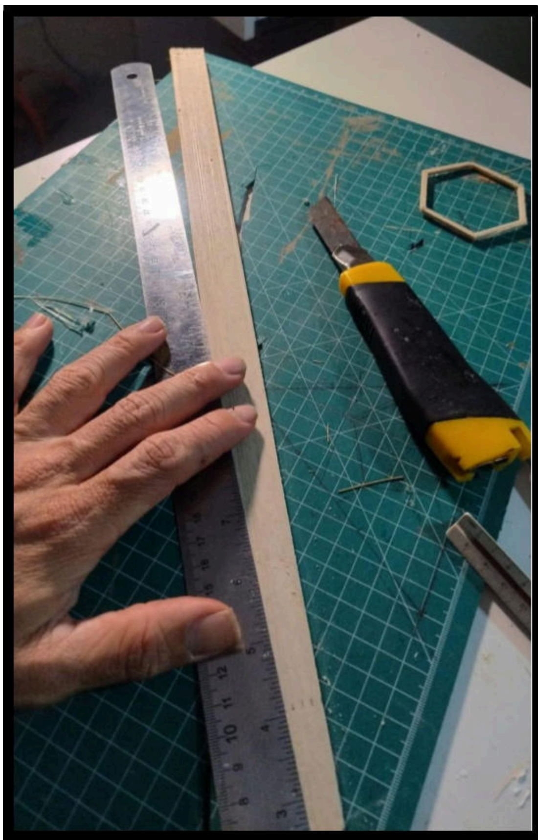
Figura 22: Medindo as ripas na escala da maquete 1:25
