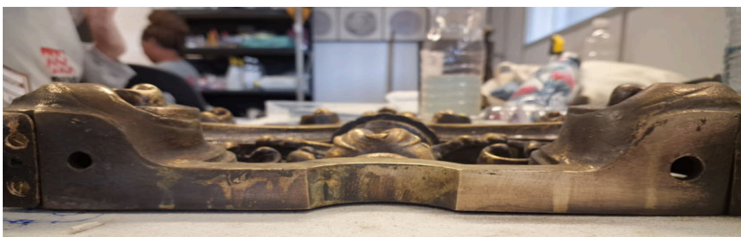
Figura 19. Antes e depois da remoção de oxidação.
