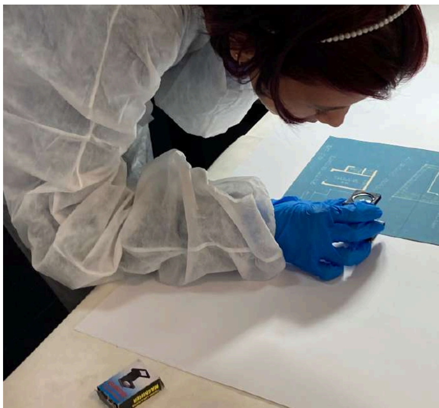
Figura 25 - Processo de análise de uma blueprint utilizando conta-fios.
