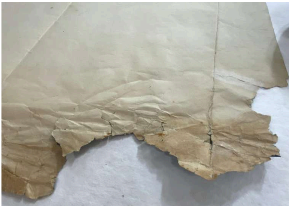
Figura 32 - Blueprint com rasgos e partes faltantes antes de recomposição.
