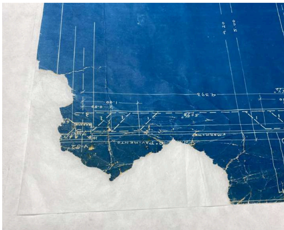
Figura 33 - Blueprint após intervenções pontuais e recomposição realizado com papel japonês e klucel g em verso.
