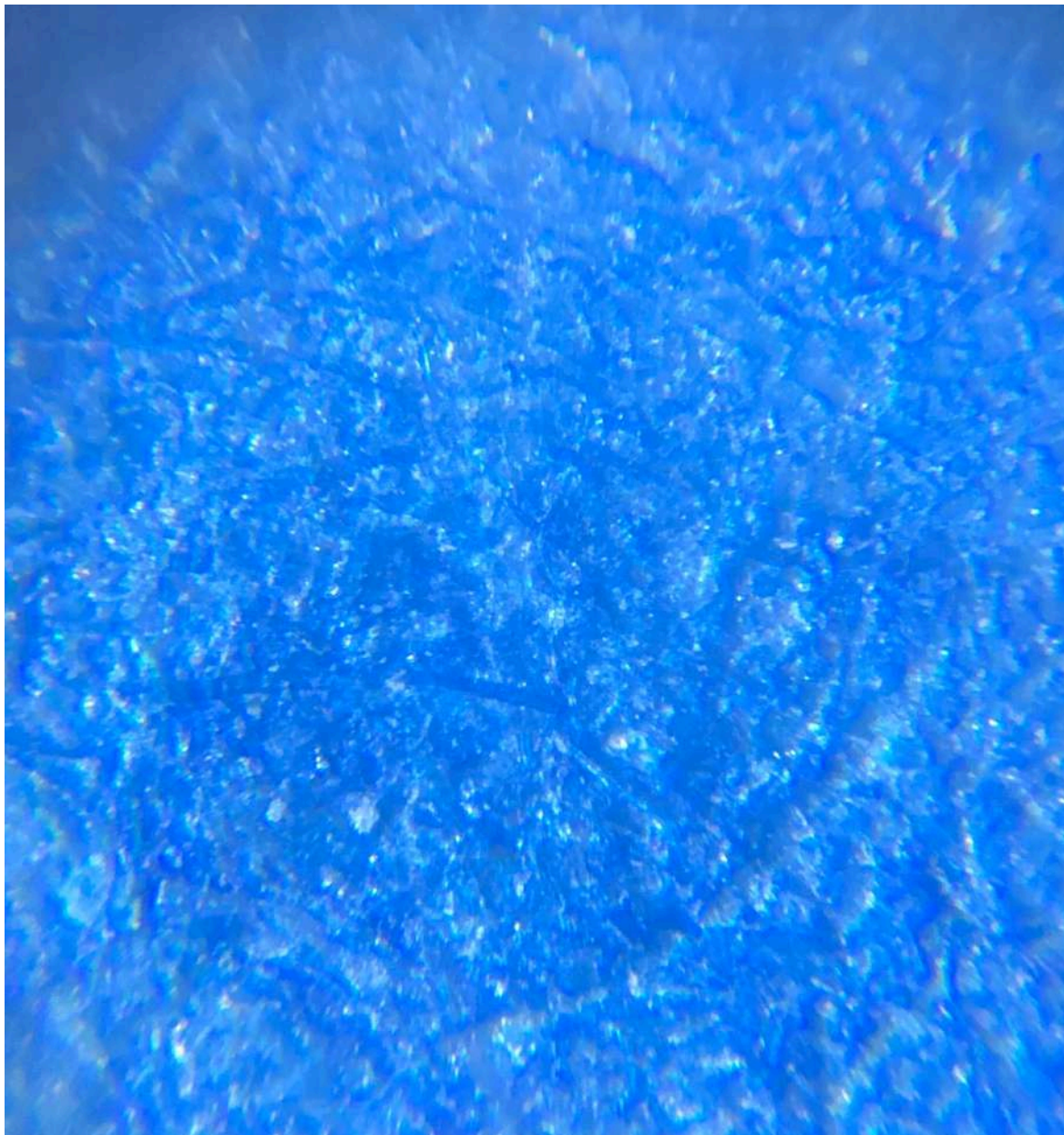
Figura 26 - Detalhes das fibras e do pigmento em documento blueprint observados em lupa de ampliação 120x.
