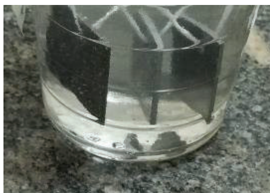
Figura 27 : Corpo de prova imerso no meio corrosivo. Fonte: Produção do próprio autor.
