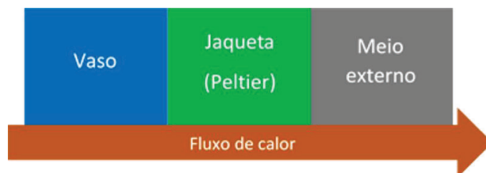
Figura 21 - Ilustração do processo de remoção de calor do vaso do reator OptiMax 1001.
