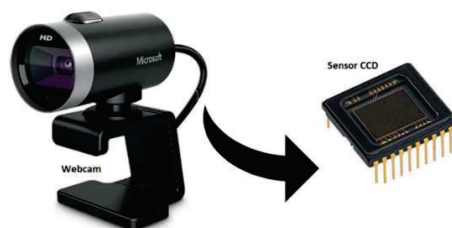
Figura 9 - Exemplo de webcam com destaque ao sensor CCD (DE OLIVEIRA, 2019).
