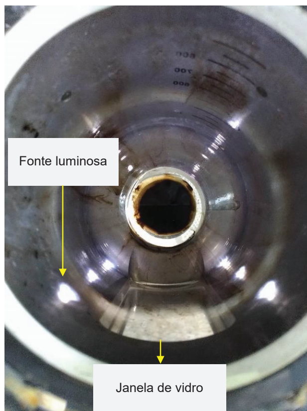
Figura 20 - Detalhe interno do vaso do reator OptiMax 1001, indicando o sistema de iluminação e a janela de visualização de vidro.
