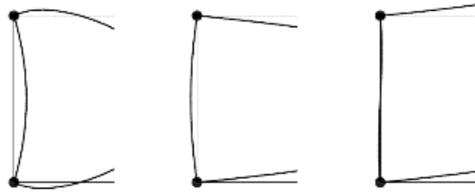
Figura 2.10: FL de perfis U submetidos à compressão axial.
