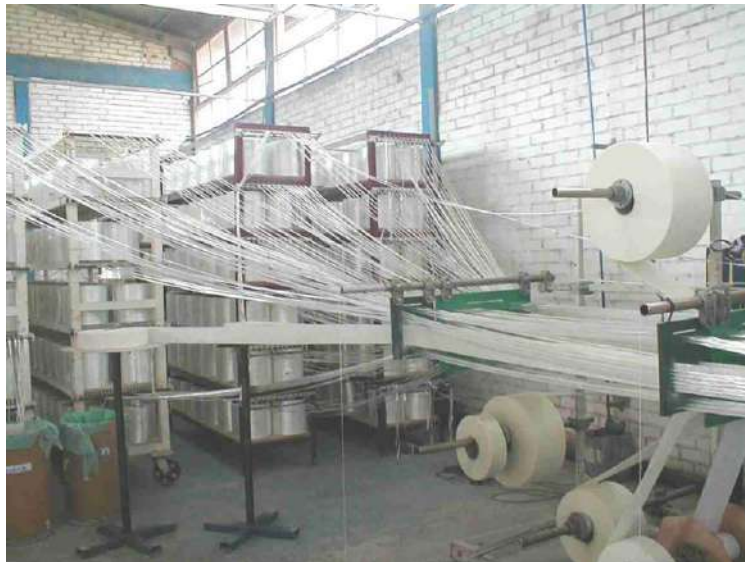
Figura 2.5: Rolos e mantas de fibra de vidro no início do processo de pultrusão.
