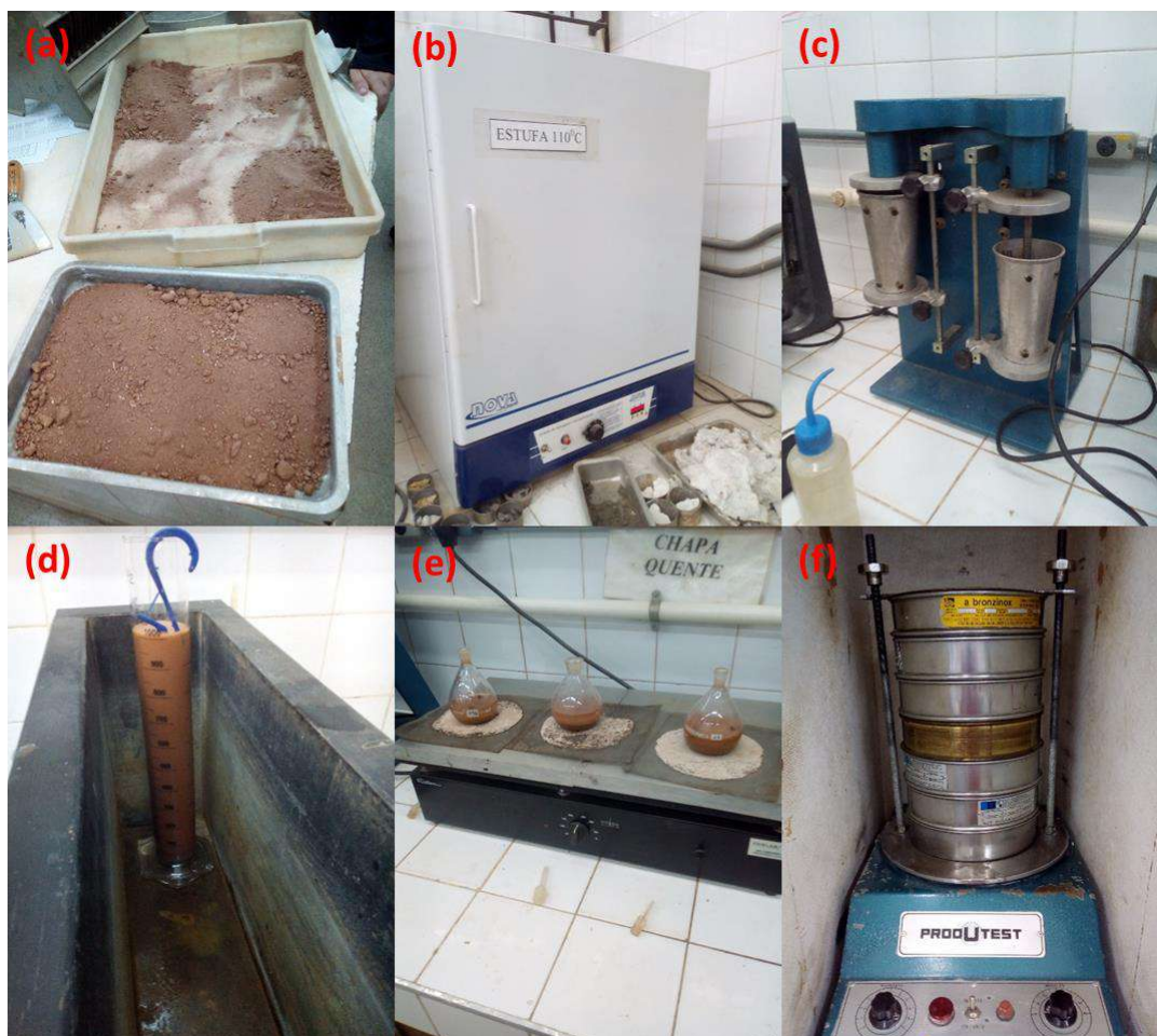
Figura 13. Quarteamento (a). Secagem em estufa a 110 °C (b). Dispersor (c). Ensaio de sedimentação (d). Amostras em picnômetros para determinação da densidade real dos grãos (e). Peneiras empilhadas prontas para o peneiramento fino (f).
