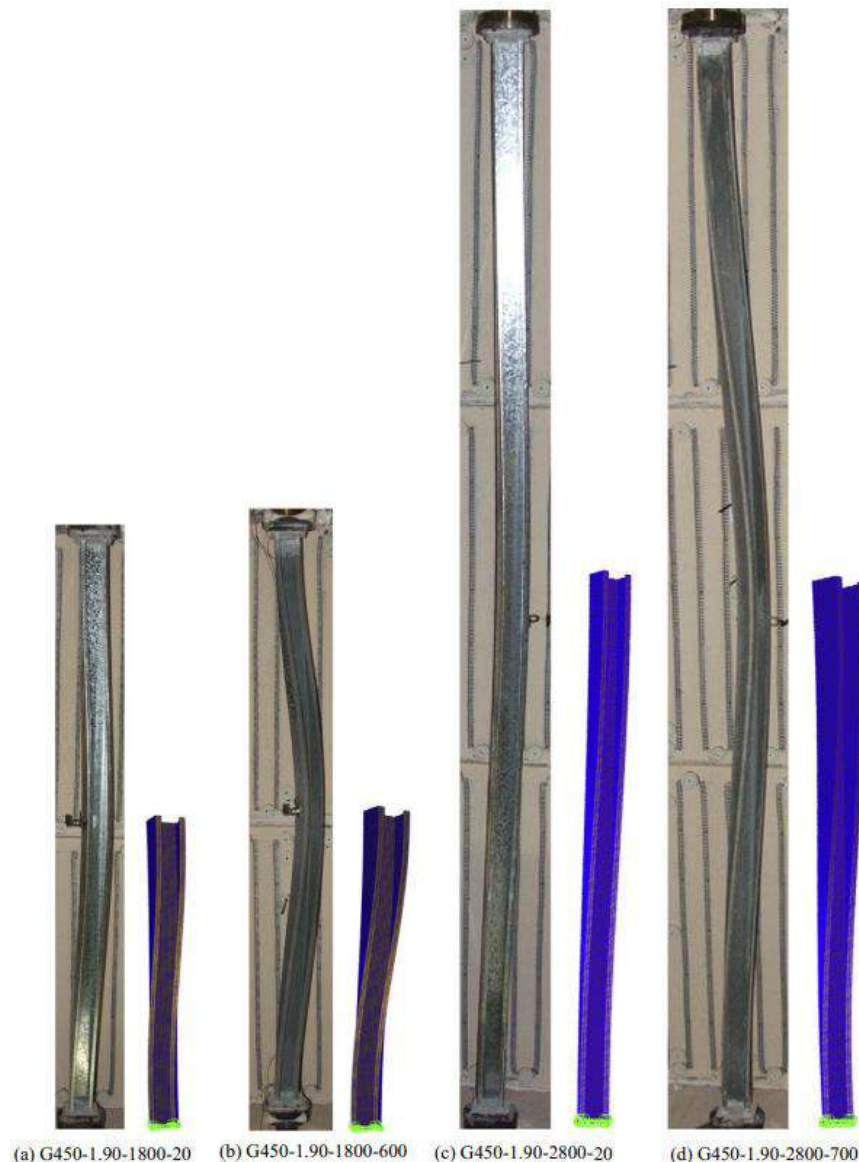
Figura 2.20: Comparação dos modos de falha do experimento com o MEF para (a) temperatura ambiente, (b) 600 °C, (c) 20 °C e (d) 700 °C. Fonte: GUNALAN et al. [49].
