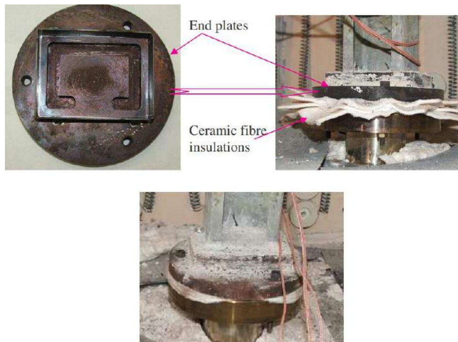
Figura 4.3: Detalhamento das placas rígidas utilizadas para simular o engaste. Fonte: HEVA [18]
