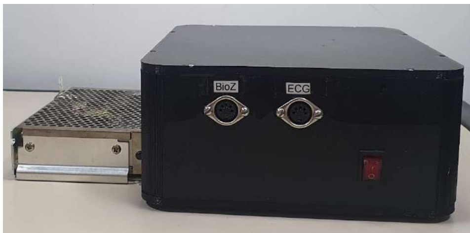
Figura 4.8 – Caixa projetada e fabricada em laboratório para armazenamento das placas desenvolvidas e de aquisição NI USB-6009, à direita da fonte de tensão de 5 V utilizada no trabalho.
