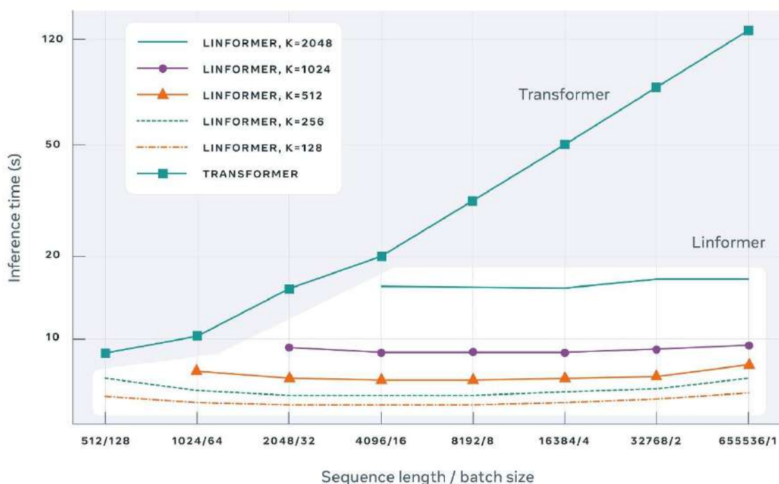
Figura 2.14: Tempo de inferência versus tamanho da sentença, com crescimento geométrico em Transformer e crescimento linear na arquitetura Linformer Fonte: WANG et al. (2020).
