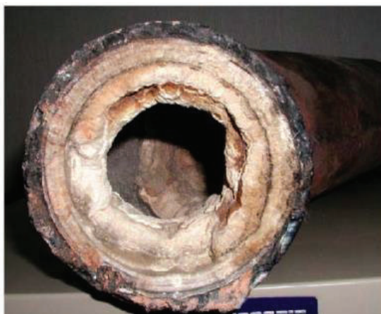
Figura 1. Tubulação com obstrução parcial por incrustação inorgânica de \text{CaCO}_3 e \text{BaSO}_4 .
