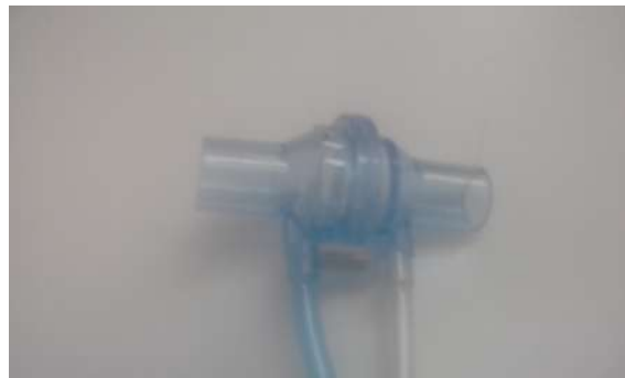
Figura 3.1: Medidor de fluxo de orifício variável utilizado nos experimentos (modelo 279331, Hamilton Medical, Suíça). O lado B está à esquerda, com tubo azul, enquanto o lado W tem o tubo branco.
