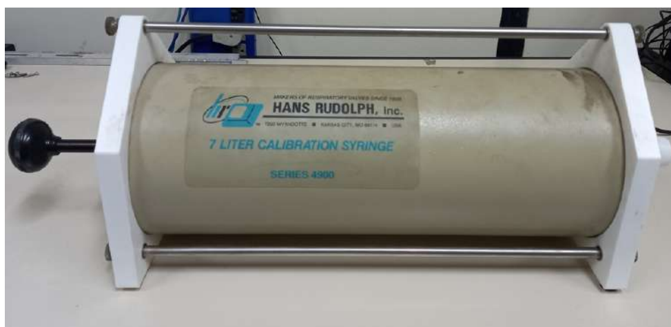
Figura 3.3: Seringa de calibração de 7 L (Série 4900, Hans Rudolph, EUA) ajustada para 3 L.
