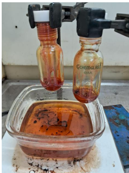
Figura 22 – Reatores utilizados na síntese tradicional aquecida por banho de óleo.
