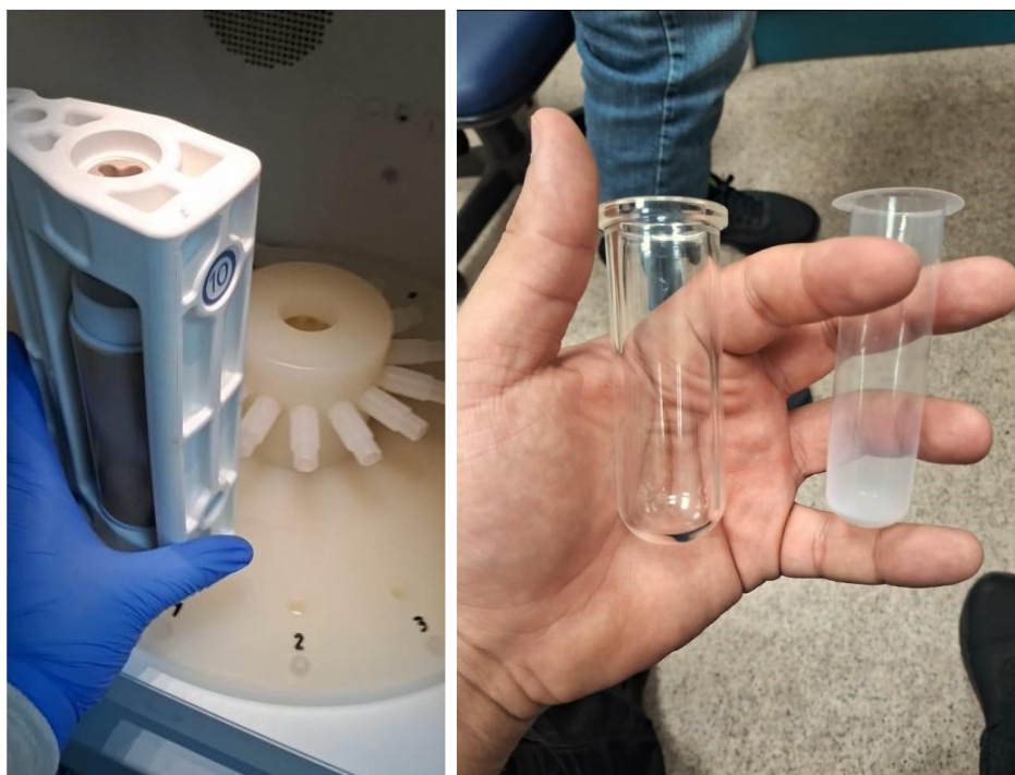
Figura 26 – Os diferentes tipos de reatores usados pelo Flexiwave e Discovery 2.0 , respectivamente
