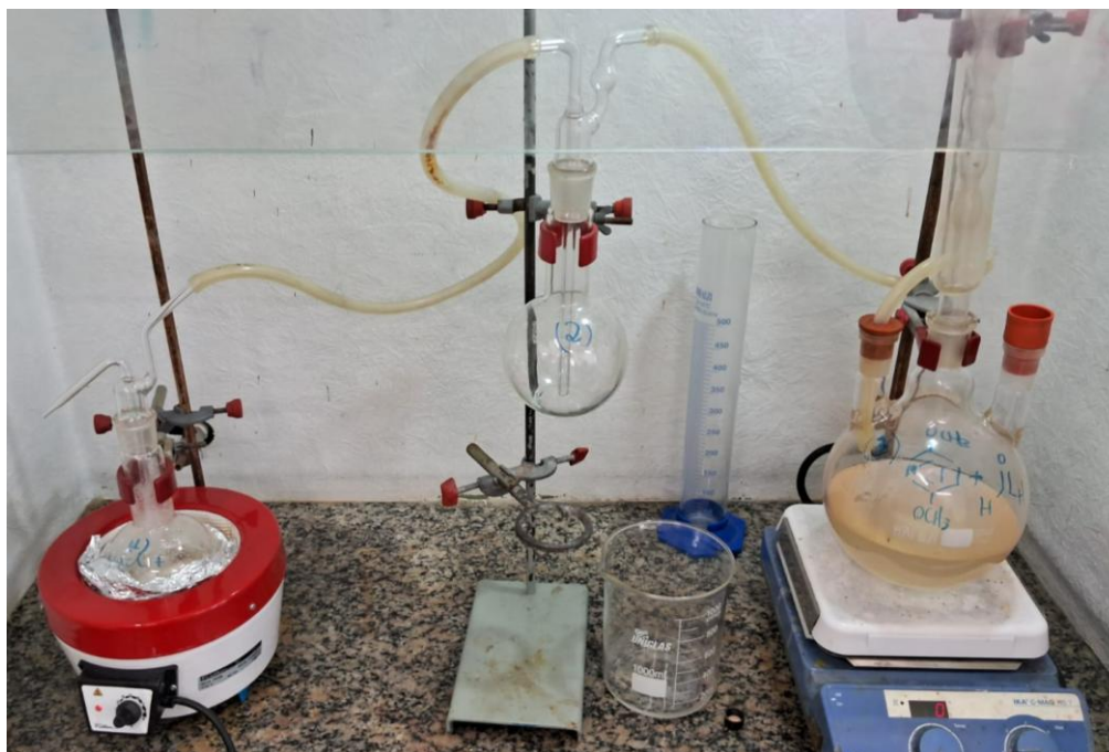
Figura 20 – Primeira etapa da síntese do DMTA. Sistema usado para produzir o 1,4-bis(clorometil)-2,5-dimetoxibenzeno, intermediário do DMTA, através do borbulhamento de HCl em um meio reacional contendo 1,4-dimetóxi-benzeno.
