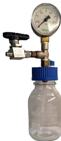
Figura 15 – Reator com manômetro acoplado e válvula para a liberação de gás utilizado neste trabalho
