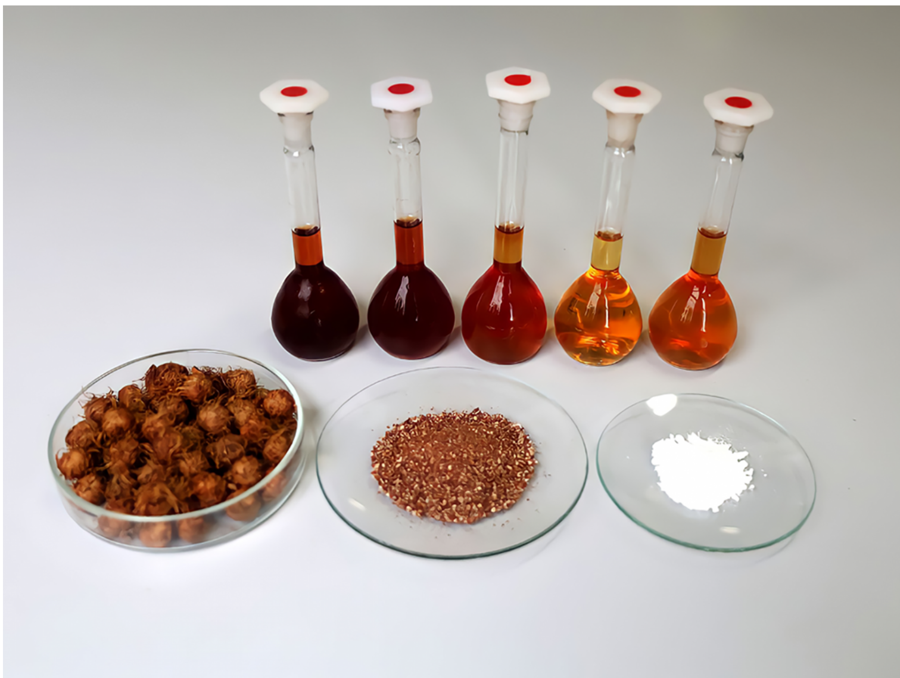
Frações obtidas da semente de açaí: sólidos (semente do fruto inteiro, semente triturada e produto liofilizado composto de manose) e líquidos (extratos de compostos polifenólicos com ação antioxidante)
