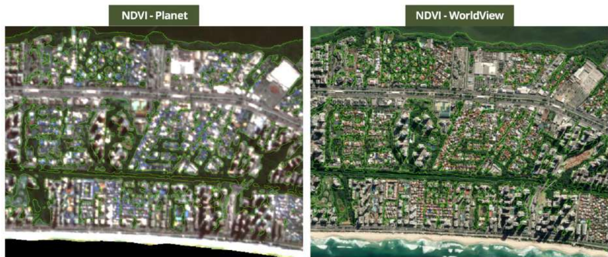
Figura 18: Área-exemplo do mapeamento de arborização (NDVI) - Barra da Tijuca/RJ. Polígonos com contorno verde representam a vegetação detectada.
