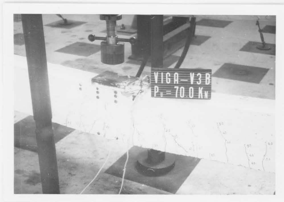
Fotografia 16 - Detalhes da ruptura da viga V-3B
