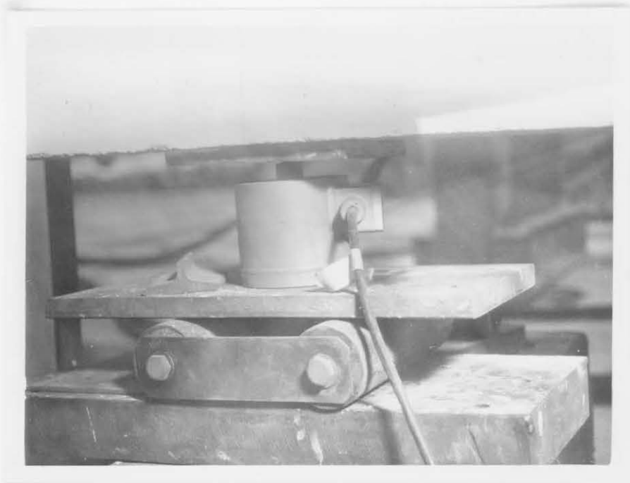
Fotografia 3 - Detalhes do apoio externo de uma viga contínua e do "LOAD CELL" usado para medir a reação de apoio.
