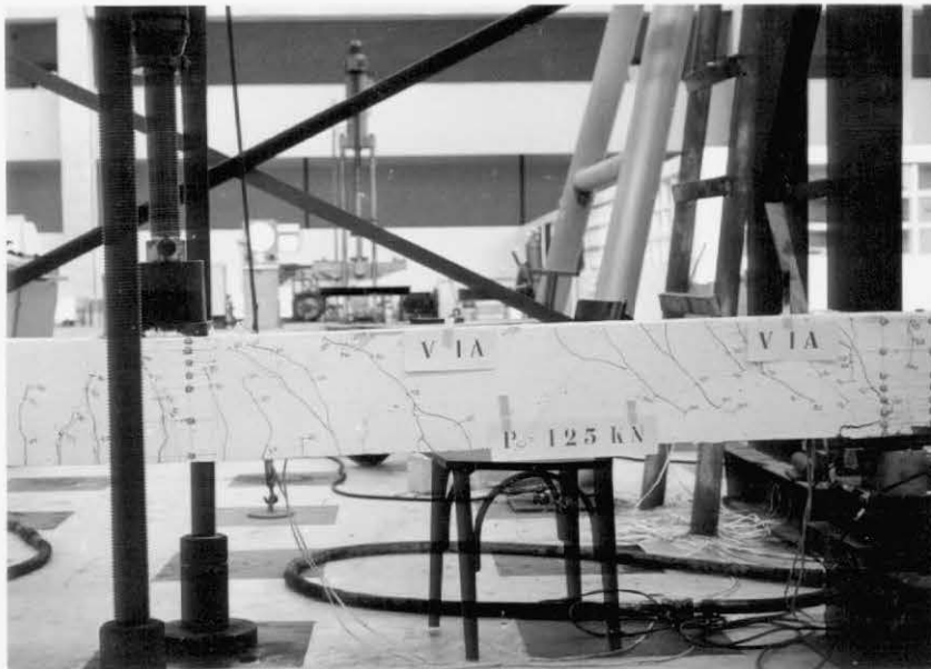
Fotografia 12 - Detalhes da ruptura da viga V-1A
