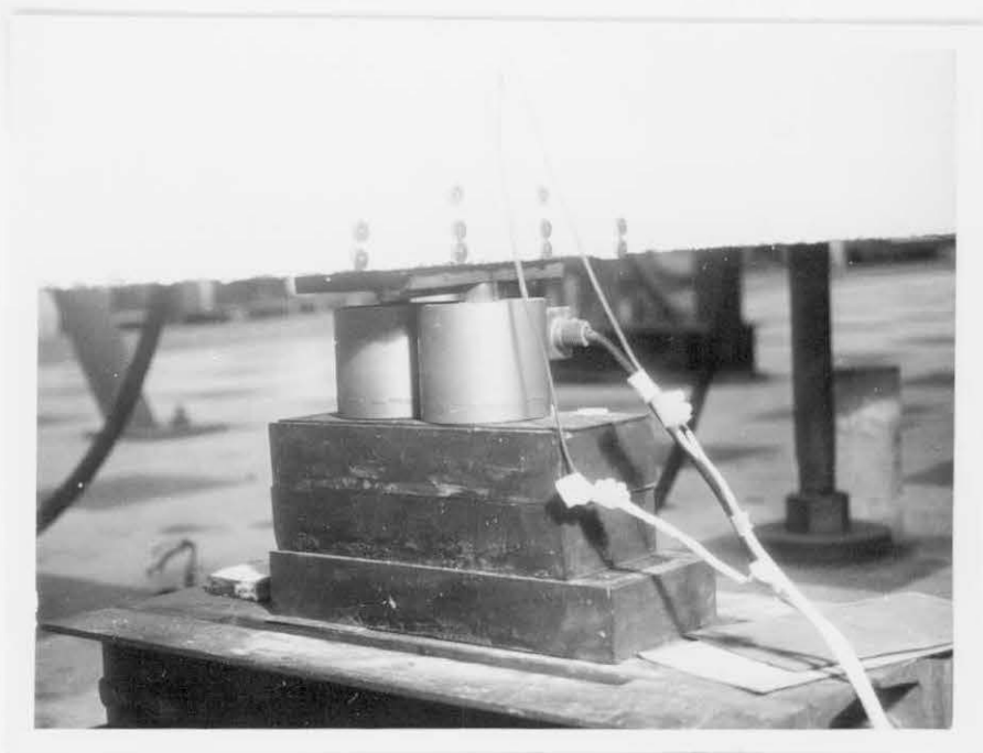
Fotografia 4 - Detalhes do apoio central de uma viga contínua e dos "LOAD CELLS" usados para medir a reação de apoio.
