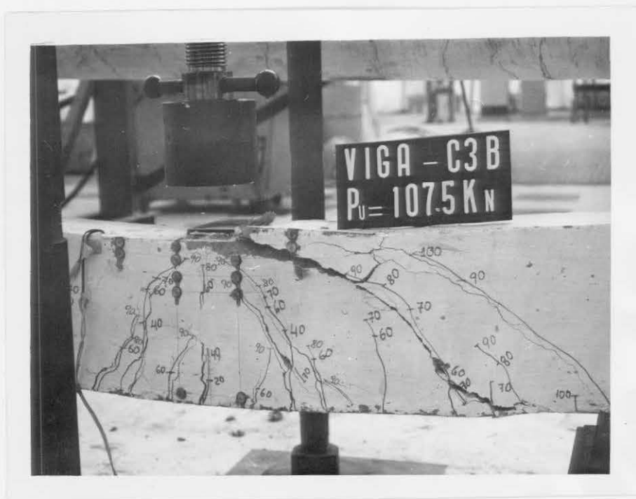
Fotografia 15 - Detalhes da ruptura da viga C-3B
