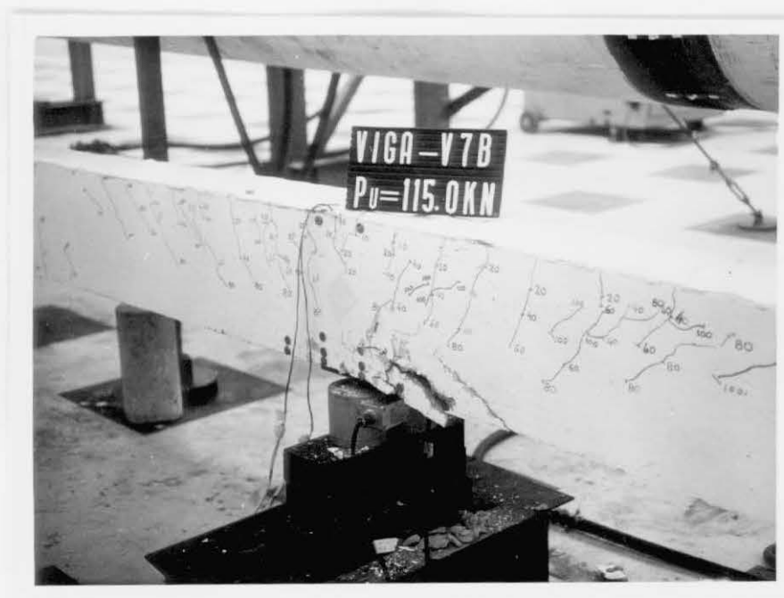
Fotografia 24 - Detalhes da ruptura da viga V-7B
