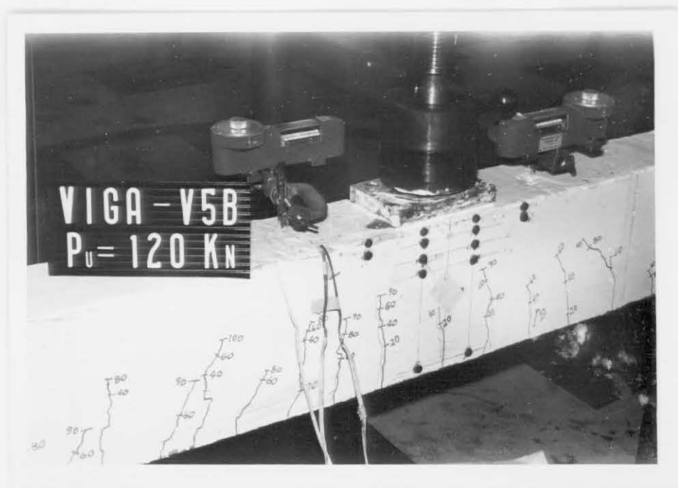
Fotografia 20 - Detalhes da ruptura da viga V-5B
