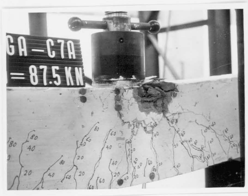
Fotografia 23 - Detalhes da ruptura da viga C-7A
