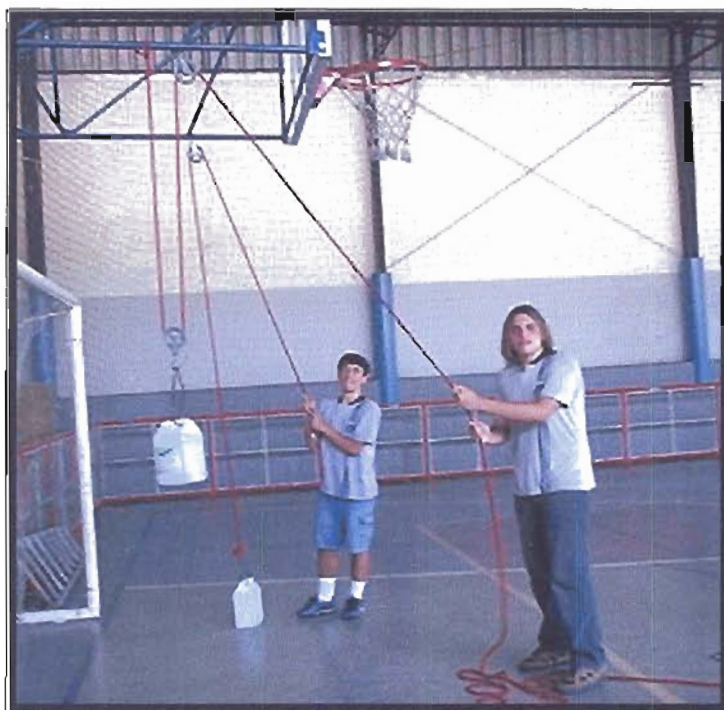
Figura 4.5- Montagem do experimento com a roldana fixa e com a roldana móvel.
