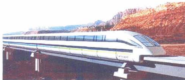
Figura 12: Esquema de um trem MAGLEV supercondutor “voando” sem nenhum tipo de apoio (e sem nenhum contato elétrico com os trilhos nem com fios externos ao trem). O trem levita e se desloca por meio da força magnética indicada na relação (1). Esta força é produzida pela interação entre o campo magnético gerado por bobinas externas (situadas ao longo da plataforma elevada) e as correntes persistentes que circulam nas bobinas supercondutoras existentes no interior do trem. [8]
