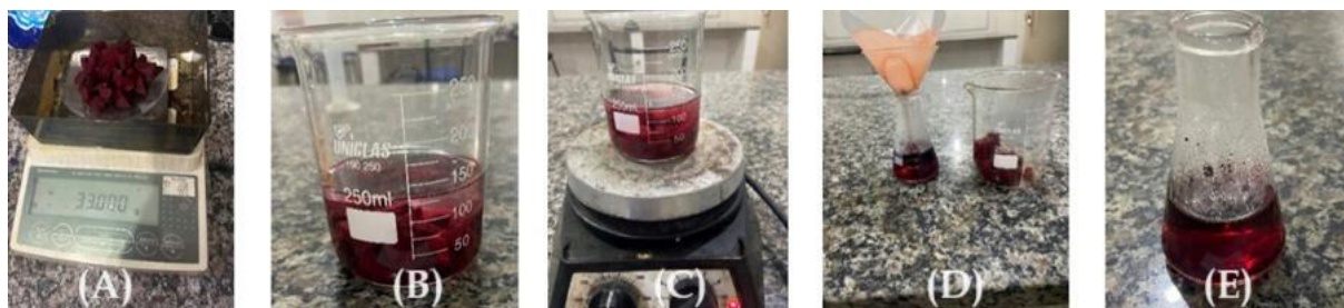
Figura 9 – Fotografias que ilustram as etapas de extração do corante da beterraba: (A) pesagem, (B) adição de água, (C) aquecimento, (D) filtragem e (E) extrato.
