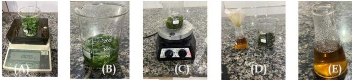
Figura 20 – Fotografias que ilustram as etapas de extração do corante do espinafre: (A) pesagem, (B) adição de etanol, (C) aquecimento, (D) filtração e (E) extrato.
