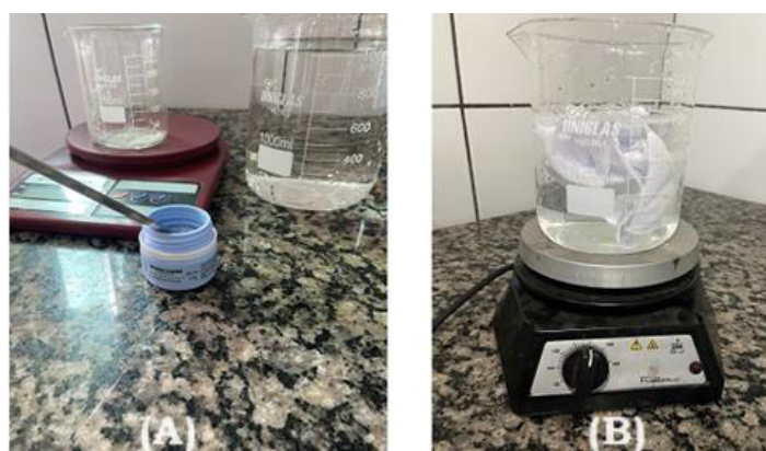
Figura 15 – Procedimento de aplicação do mordente para a fixação dos corantes naturais nos tecidos antes do tingimento: (A) pesagem do alúmen de potássio e (B) aquecimento do tecido, com alúmen de potássio em água.
