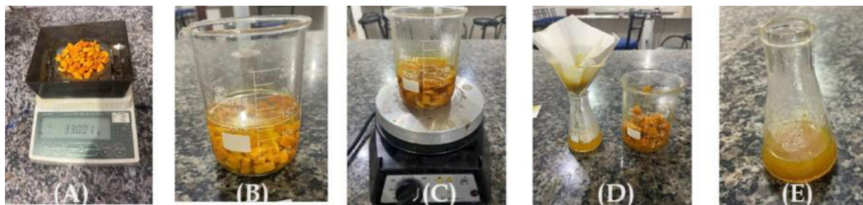
Figura 8 – Fotografias que ilustram as etapas de extração do corante do açafrão da terra: (A) pesagem, (B) adição de etanol, (C) aquecimento, (D) filtração e (E) extrato.
