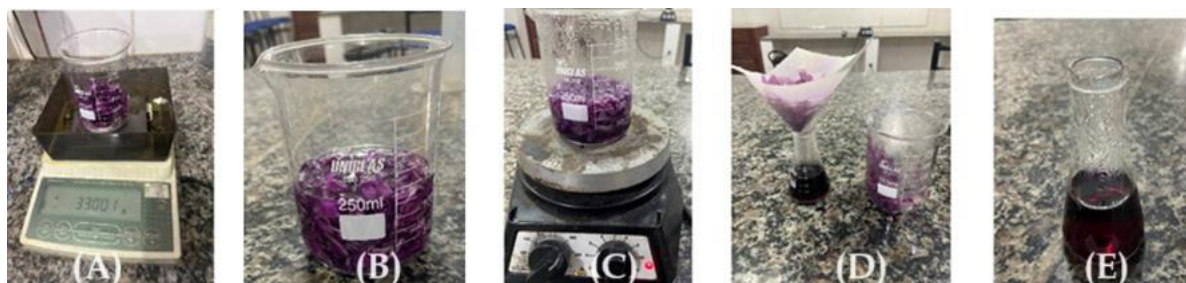
Figura 10 – Fotografias que ilustram as etapas de extração de corante do repolho roxo: (A) pesagem, (B) adição de etanol, (C) aquecimento, (D) filtragem e (E) extrato.
