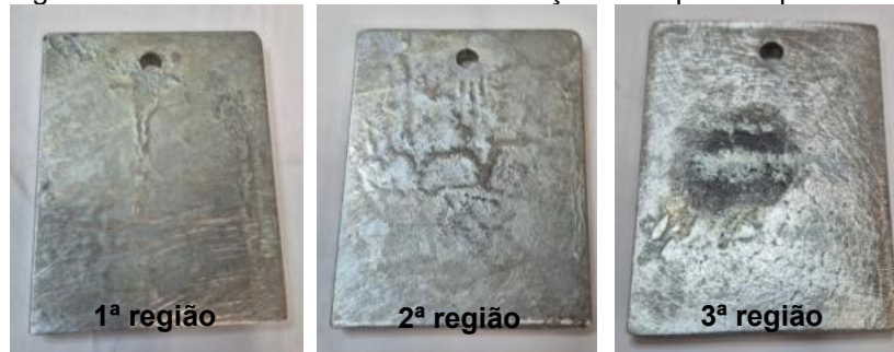
Figura 30 – Resultado do teste de verificação de superfície passivada.
