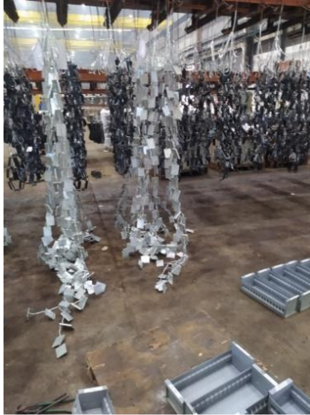
Figura 12 – Arranjo de parte dos corpos de prova na linha de produção da Raitz Galvanização.
