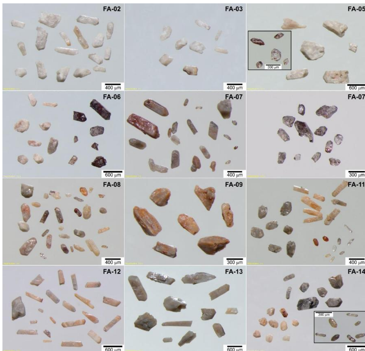
Figura 67 – Exemplos de grãos de zircão dos pegmatitos estudados. Em detalhe nas amostras FA-05 e FA-14, assim como nas amostras FA-07 (segunda imagem) e FA-11 é possível observar cristais de zircão transparentes (não metamicticos) que foram separados para estudos de geocronologia. Nas fotomicrografias é possível observar as diferentes cores apresentadas pelo zircão assim como seu hábito prismático característico alongado.
