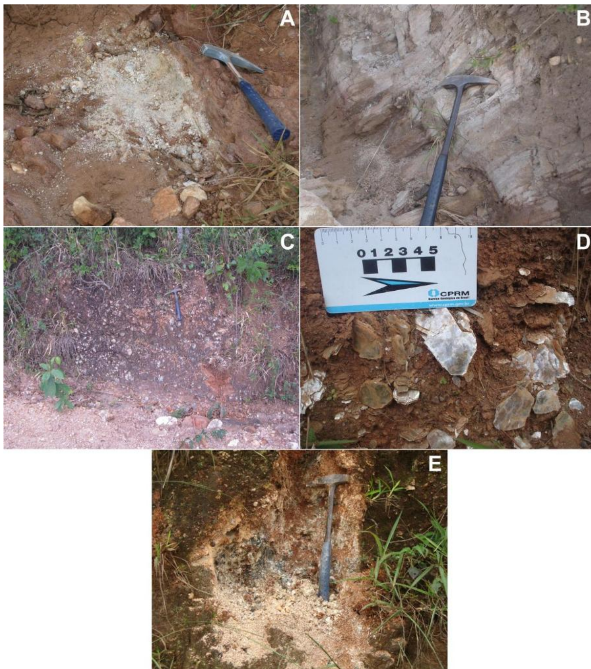
Figura 18 – A) Pegmatito intrusivo na unidade metassedimentar da sequência metavulcano-sedimentar Rio das Mortes, ponto FA-09. B) Quartzitos que compõem a unidade metassedimentar da sequência metavulcano-sedimentar Rio das Mortes, próximo ao ponto FA-09. C) Pegmatito intrusivo em filitos da unidade metassedimentar da sequência metavulcano-sedimentar Rio das Mortes amostrado no ponto FA-10. D) Detalhe das placas centimétricas de muscovita encontrados no ponto FA-10. E) Ponto FA-12: pegmatito intrusivo em anfibolitos da sequência metavulcano-sedimentar Rio das Mortes onde é possível observar a presença de óxi-hidróxidos de Mn (manchas escuras).
