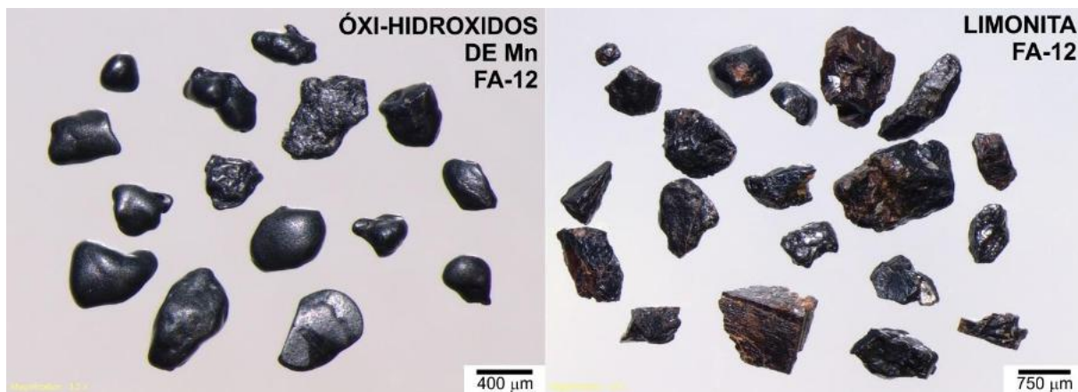
Figura 71 – Exemplos de grãos de óxido/hidróxido de Mn e de limonita retirados da amostra FA-12. Os grãos de óxi-hidroxidos de Mn apresentam uma cor característica cinza grafite, hábito botrioidal e forma arredondada na maioria dos grãos. A limonita pode apresentar hábito cúbico ou fragmentos formando arestas de cubo (provável pseudomorfo de pirita).
