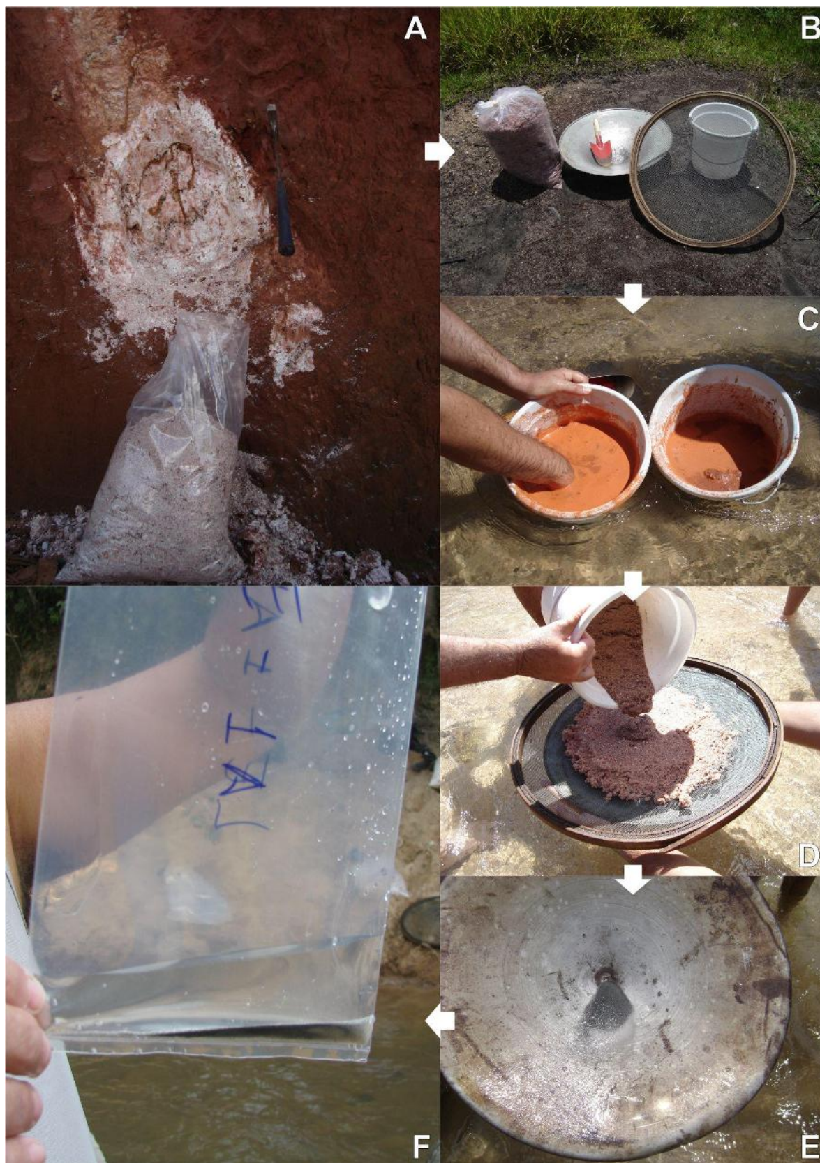
Figura 5 – Processo de amostragem e concentração em campo das amostras coletadas. A) amostragem de corpo pegmatítico intemperizado (~20 kg), B) material básico para amostragem e concentração em campo, C) deslamagem em leito ativo, D) peneiramento em malha de 2 mm, E) concentração em bateia, F) produto final com os minerais pesados.
