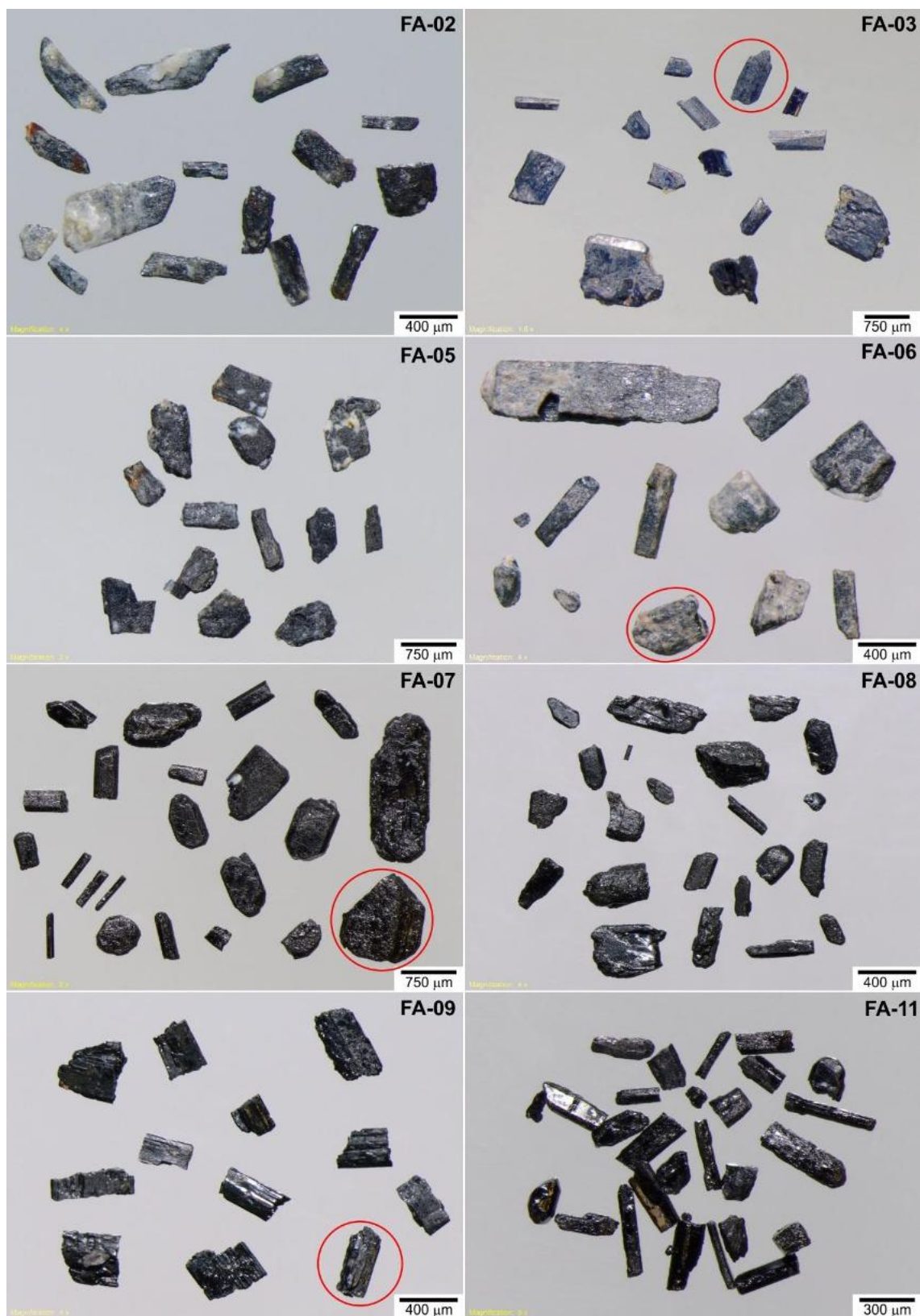
Figura 64 – Exemplos de grãos de columbita/tantalita provenientes dos pegmatitos estudados. Hábito tabular com terminação em ponta de flecha é comum de ser encontrado (círculo vermelho). Coloração preta e brilho metálico intenso podem ser melhor observados nas amostras FA-07 e FA-11.
