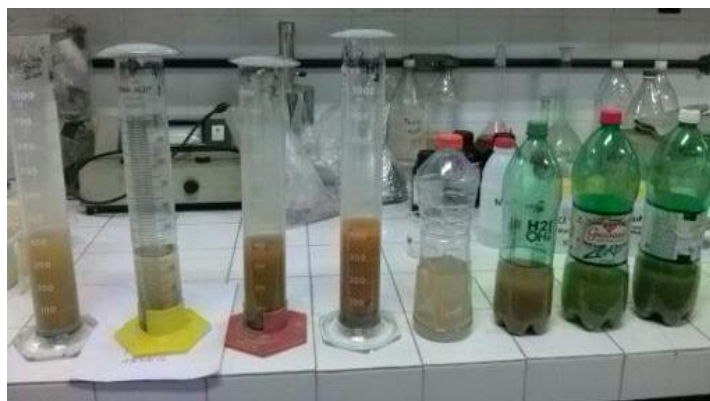
Figura 10 Amostras W1 a W4, da esquerda para a direita, após o processo final de sifonamento das provetas para obtenção da fração argila e armazenamento da mesma em garrafas pet.
