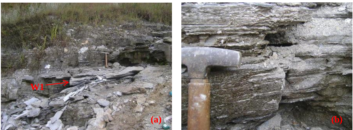
Figura 35 Em (a), evidência de W1 que ocorre entre níveis W3. Apesar da rocha ser considerada sã, ela apresenta forte deslocamento nos planos de foliação. Em (b), trecho de contato entre as classes W4 e W3 com forte alteração entre os planos de foliação.
