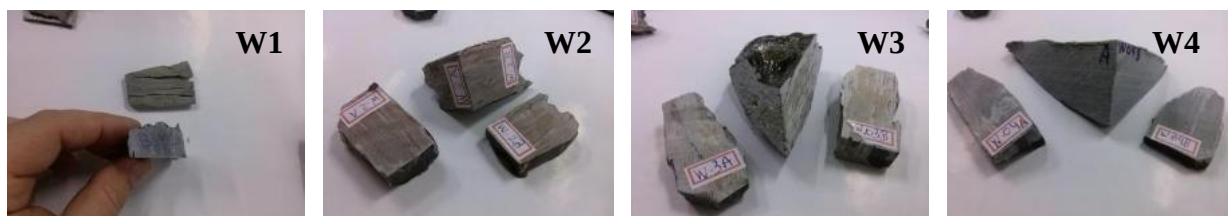
Figura 6 Detalhes de amostras e cortes para lâminas petrográficas em função da foliação.
