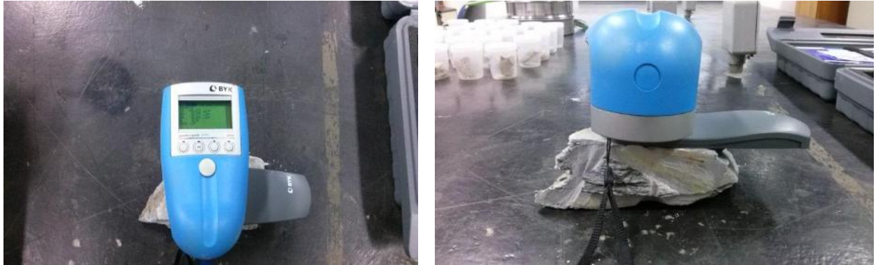
Figura 17 Detalhes do colorímetro durante o teste da cor na matriz da rocha.
