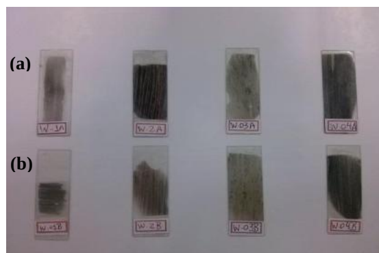
Figura 7 Lâminas delgadas para os níveis W1 a W4. Em (a) sentido paralelo à foliação e em (b) sentido ortogonal à foliação.
