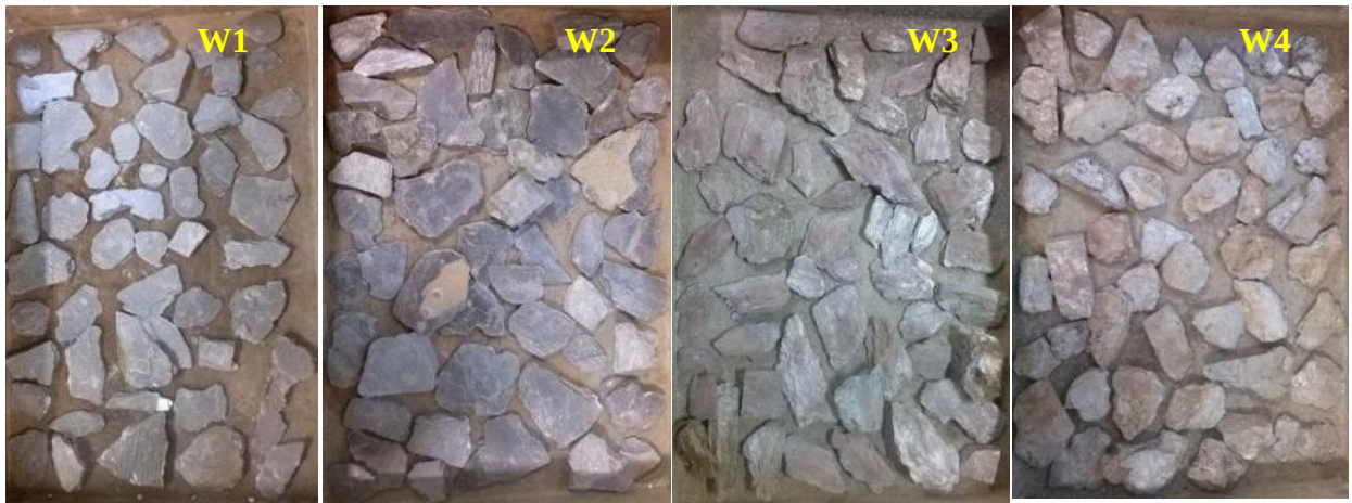
Figura 20 Fragmentos dos níveis W1 a W4 para ensaios de ciclagem água-estufa.
