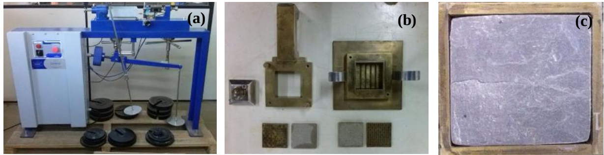
Figura 28 Detalhe de prensa de solos para cisalhamento direto (a) e caixa de cisalhamento. Em (c) corpo de prova de amostra W1 moldado nas dimensões para a caixa de cisalhamento (5 x 5 x 2 cm).
