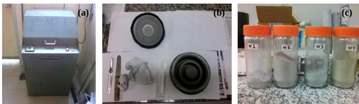
Figura 8 Em (a) moinho utilizado para moagem das amostras. Em (b) acessórios utilizados no processo de moagem. Em (c) níveis de alteração, W1 a W4, já reduzidos a pó de rocha.
