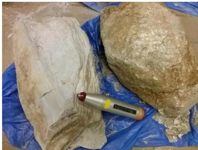
Figura 5 Blocos rochosos de filito coletados para ensaios de laboratório. À esquerda nível W1 e a direita nível W4.
