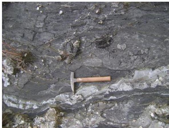
Figura 37 Veios de quartzo que ocorrem em trechos do perfil de alteração, intercalados com a rocha filito. Sua evidência é mais proeminente em níveis W3 e principalmente W4.
