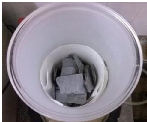
Figura 22 Detalhe de amostras em cartucho feito com papel filtro no interior do extrator Soxhlet.
