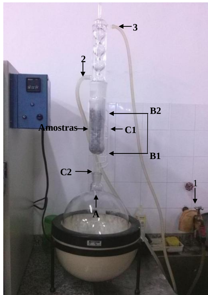
Figura 23 Esquema de montagem do extrator Soxhlet. (1) representa a alimentação contínua de água ao condensador, entrando em (2) e saindo em (3). A água aquecida no balão volumétrico produz vapor (A) que percorre o canalículo (B1 a B2) até o extrator Soxhlet. O vapor sofre condensação e umedece o cartucho de papel filtro com as amostras. Quando a água atinge o sifão em (C1) é finalizado um ciclo, onde o fluido retorna por (C2) para o início do ciclo seguinte.
