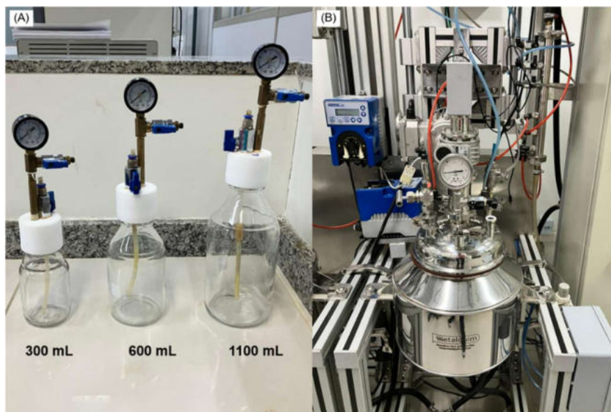
Figura 9 – Imagens dos reatores utilizados nos experimentos. (A) Reatores manométricos de vidro de 300, 600 e 1100 mL e (B) reator STR de 7000 mL.
