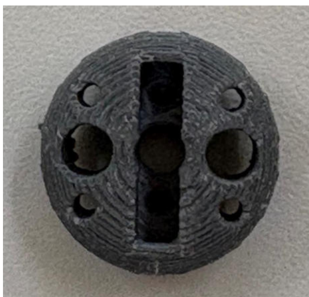
Figura 12: Aspecto visual do suporte de C-PLA após a etapa de funcionalização por radicais hidroxila ( \bullet\text{OH} ).
