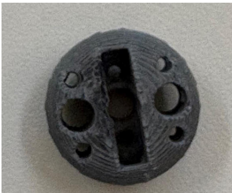
Figura 13: Aspecto do suporte C-PLA-OH após o processo de silanização.
