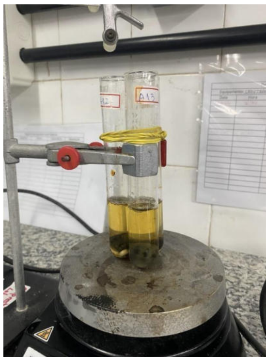
Figura 15: Reação de imobilização da Lacase.
