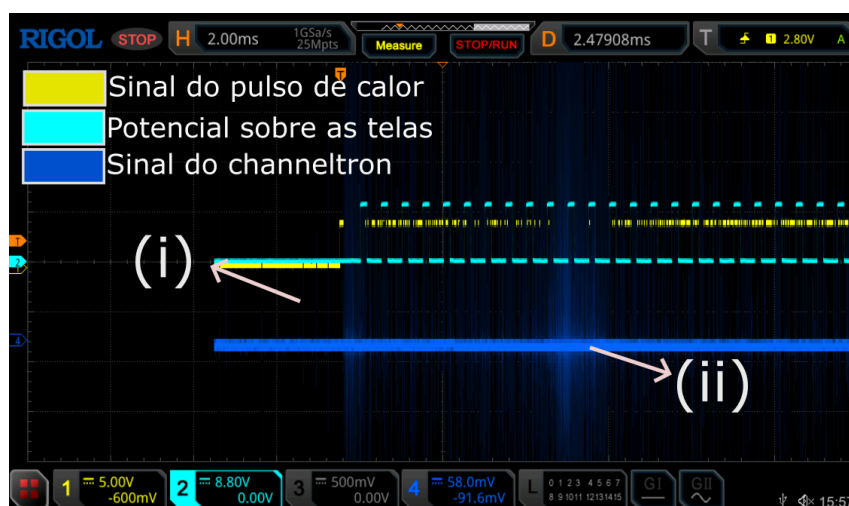
Figura 4.20: Captura de tela do osciloscópio durante a RUN 6084 na qual ocorreu a implantação dos átomos. A posição (i) ocorre logo após a aplicação do pulso de calor. A posição (ii) ocorre no momento do aparecimento do primeiro sinal atômico dos dados desta RUN mostrados nas figura 4.21.
