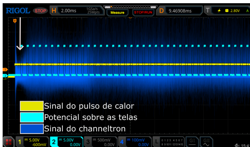
Figura 4.19: Captura de tela do osciloscópio durante a RUN 6081 na qual ocorreu a implantação dos átomos. A seta branca indica a saturação do channeltrons devido a um alto número de contagens de elétrons.
