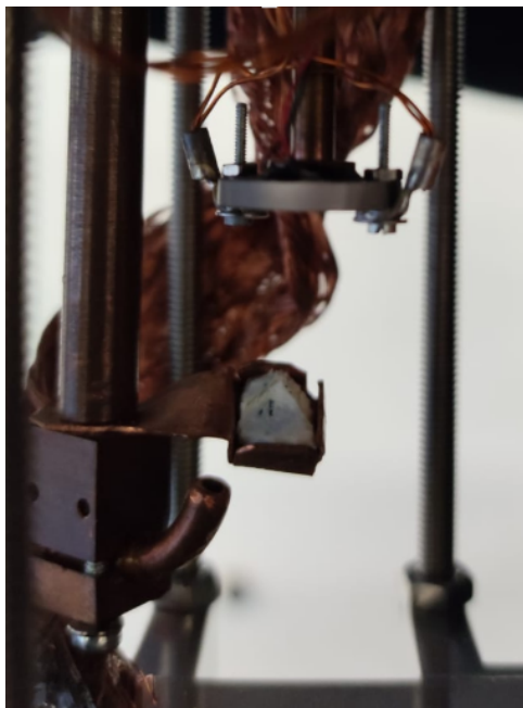
Figura 3.4: Pedra de hidreto de lítio posicionada próxima a safira pelo suporte de cobre. A cor branca da pedra é causada por uma camada superficial de oxidação do LiH e os pontos pretos são as regiões nas quais ocorreram as ablações.
