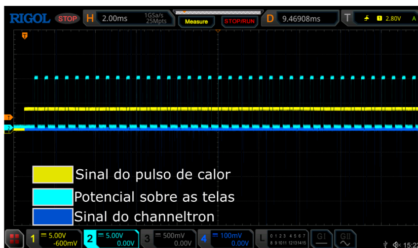
Figura 4.18: Captura de tela do osciloscópio durante a RUN 6077 na qual não ocorreu implantação dos átomos. O sinal amarelo é o sinal TTL do pulso de calor. Em azul apresentamos o sinal do channeltron. Em ciano, apresentamos o sinal do potencial aplicado nas telas.
