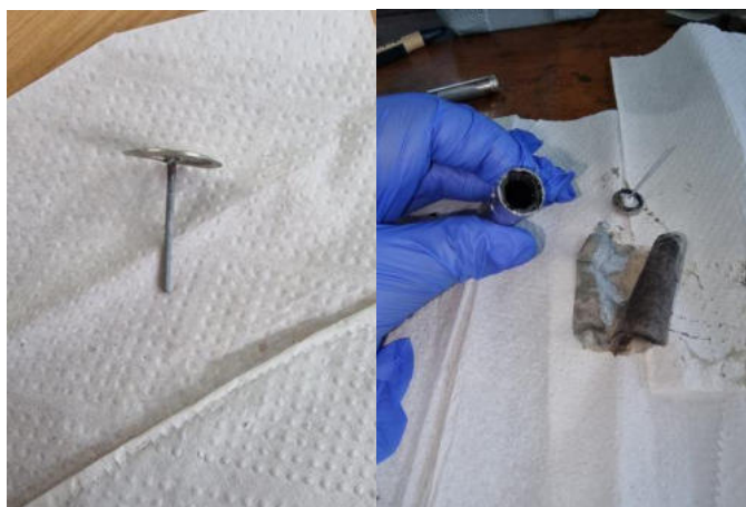
Figura 6 – Abertura de uma pilha alcalina
