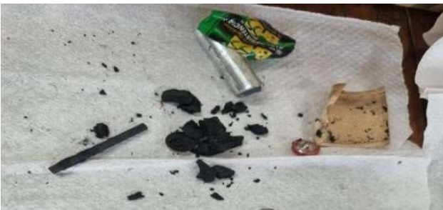
b) Eletrodo de grafite extraído da pilha em estudo
