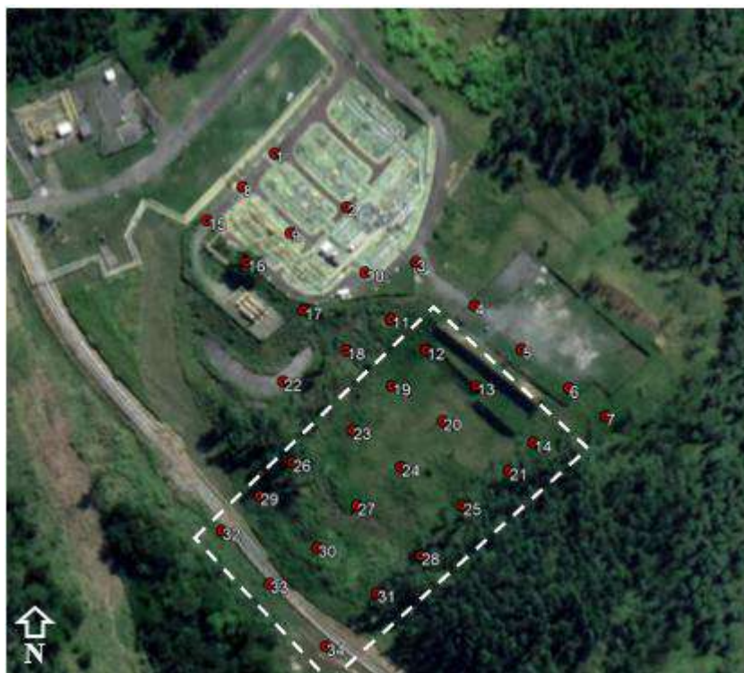
Figura 74 - Pontos para avaliação da coerência interferométrica, com indicação da área em rastejo (retângulo tracejado)
