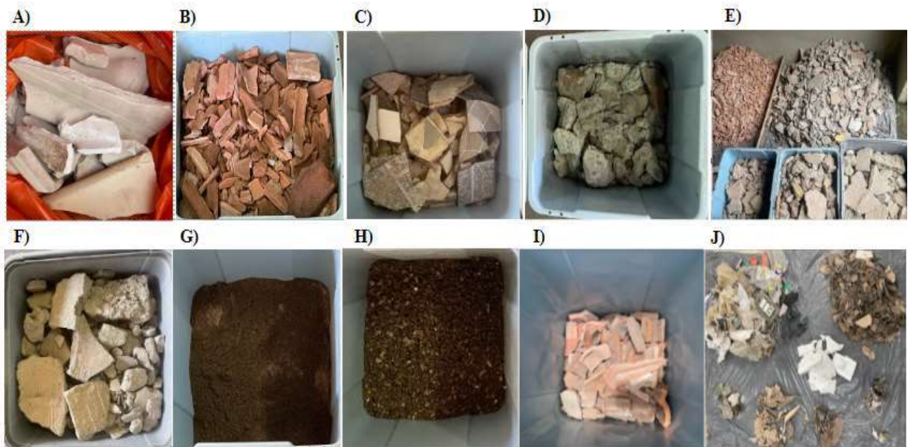
Figura 10. Parcela da composição gravimétrica de RCC a saber: (A) cerâmica branca, (B) cerâmica vermelha, (C) ladrilhos, (D) concreto, (E) argamassa e cerâmica vermelha, (F) argamassa, (G) areia, (H) agregados finos, (I) cerâmica vermelha e (J) folhas, vidro, plásticos, isopor, metal, Etapa 2.
