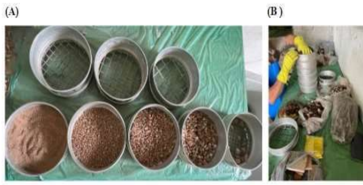
Figura 6. (A) Separação dos agregados fino por peneiras e (B) segregação dos resíduos.
