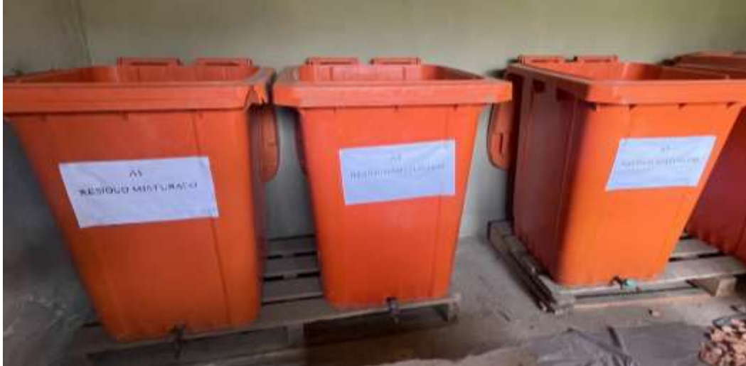
Figura 13. Células dispostas sobre suporte de madeira com acesso aberto para adição de água.
